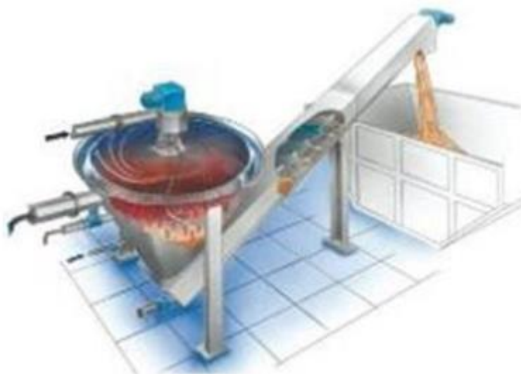
Slika 11.1.2.1. Uređaj za ispiranje pijeska
