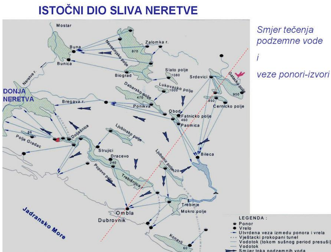
Slika 4.1.3.1. Smjer tečenja podzemne vode
