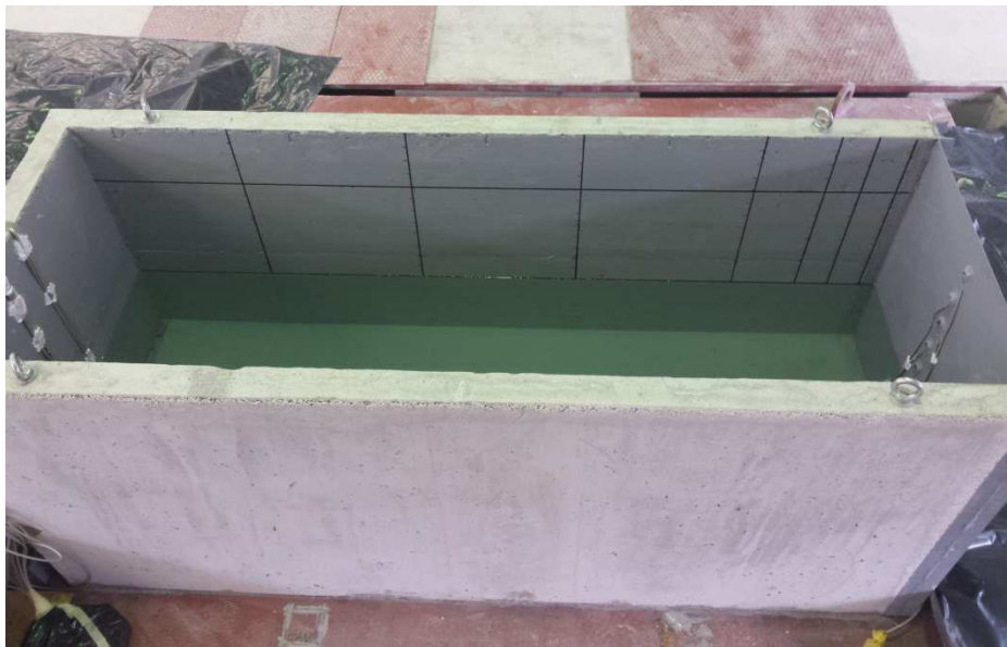
Slika 5.2. Fotografija rezervoara R2 spremnog za ispitivanje
