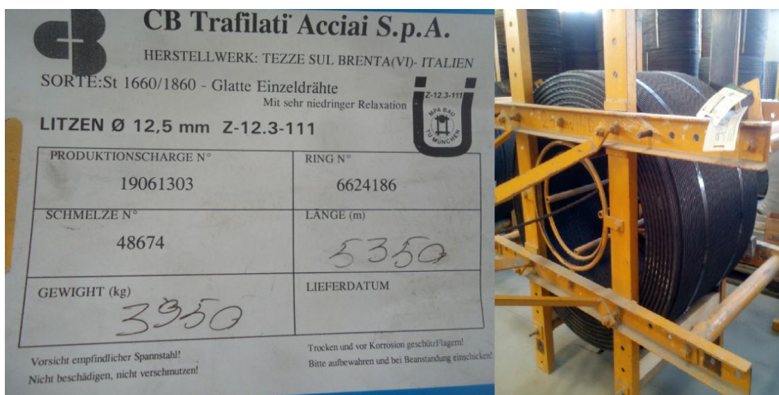
Slika 4.2 Karakteristike čeličnog užeta
