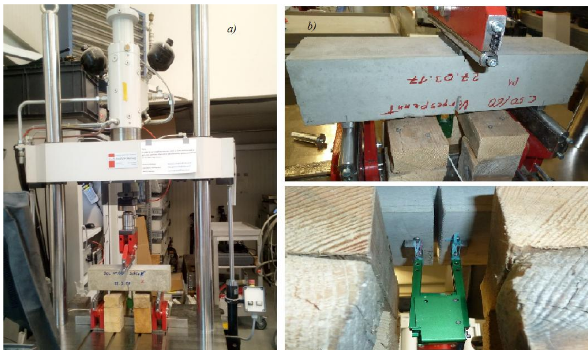
Slika 4.34 a) uređaj za testiranje; b) uzorak za vrijeme ozvođenja testa; c) mjerni uređaj (senzor)
