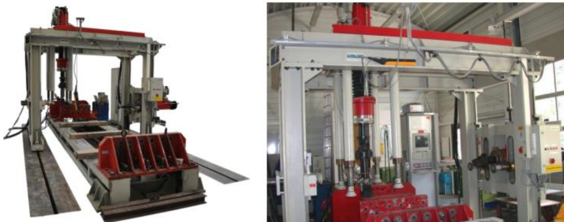
Slika 4.17 Uređaj za izvođenje pull- out testa IKI-02 [17]
