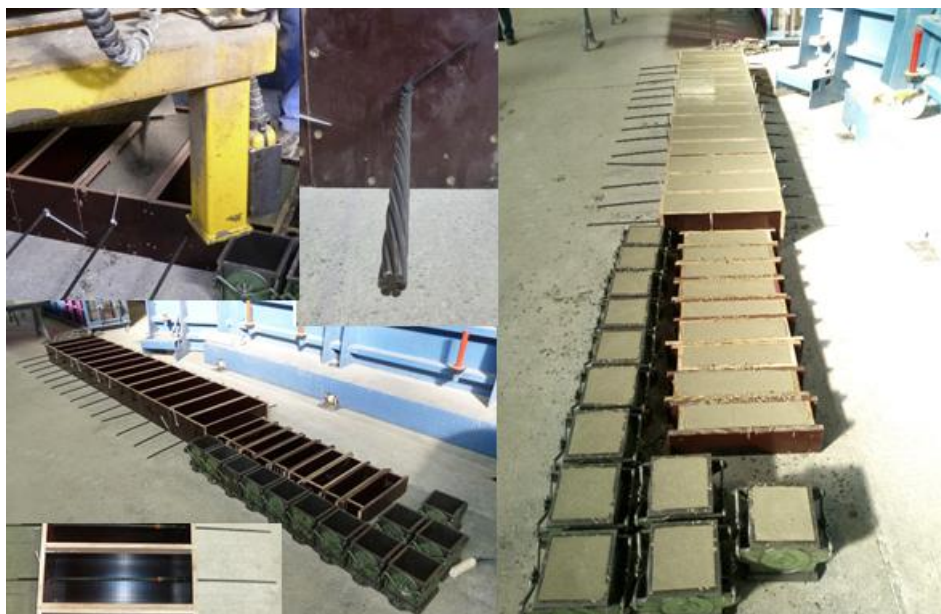
Slika 4.10 Uzorci betona koji nije prednapet
