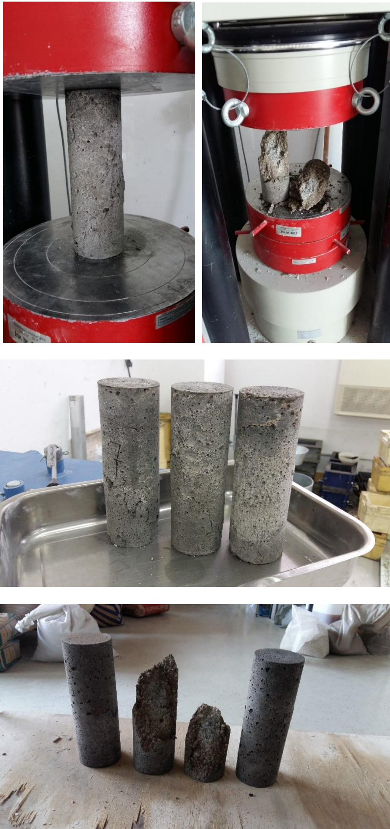
Slika 6.6. Ispitivanje tlačne čvrstoće uzoraka mješavine SCC5 [slike zabilježene tijekom ispitivanja]
