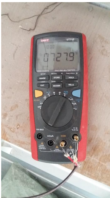
Slika 6.29. Temperatura unutar strukture uzorka 24 mješavine SCC7
