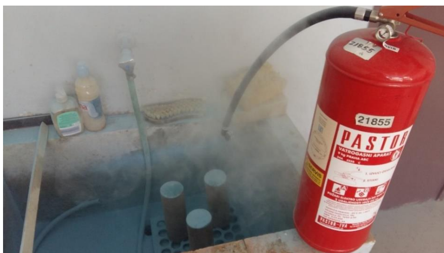
Slika 6.13. Izlaganje uzoraka prahu vatrogasnog aparata [slika zabilježena tijekom ispitivanja]
