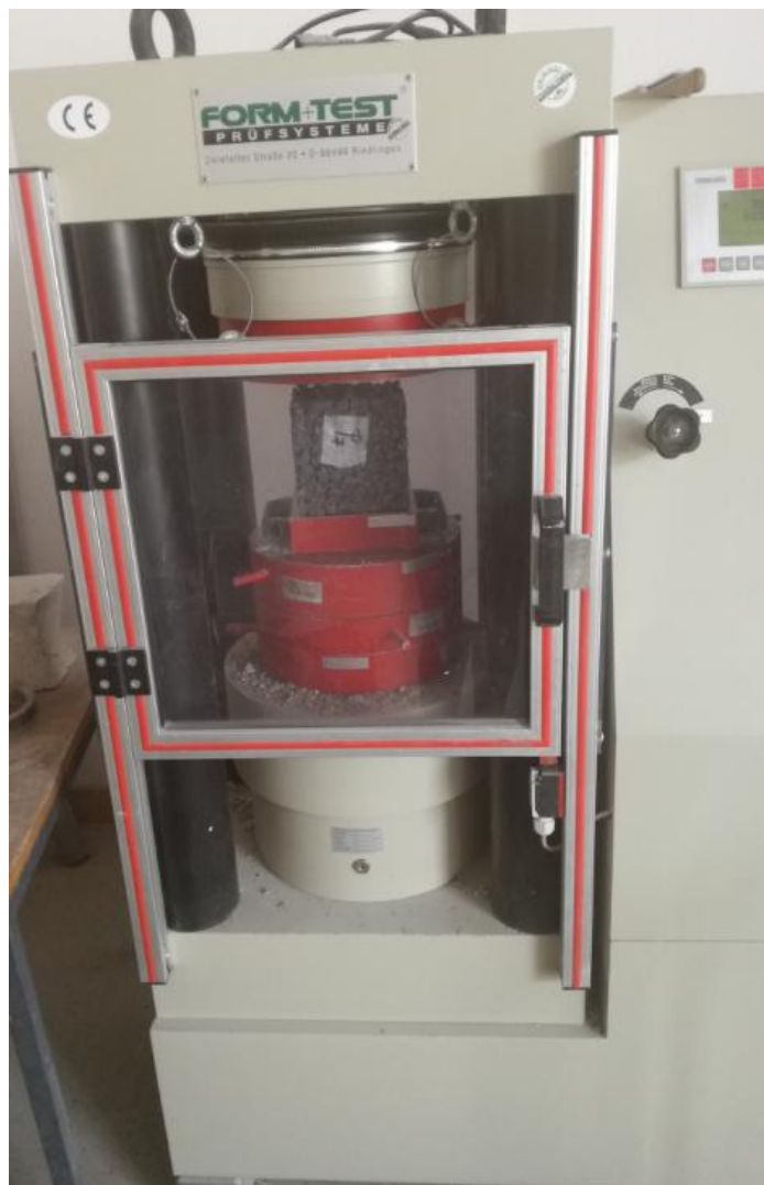
Slika 4.11 Ispitivanje tlačne čvrstoće hidrauličkom prešom
