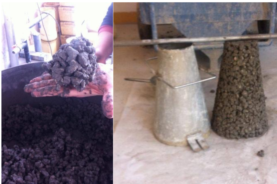
Slika 5.4 Ispitivanje konzistencije mješavine P 4
