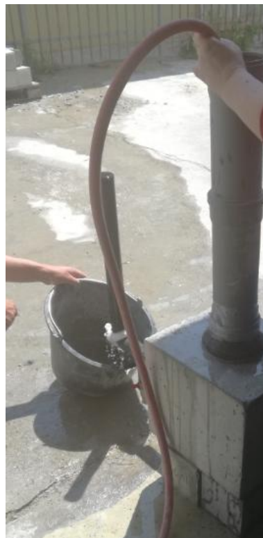
Slika 4.10 Ispitivanje propusnosti metodom stalne razine stupca vode
