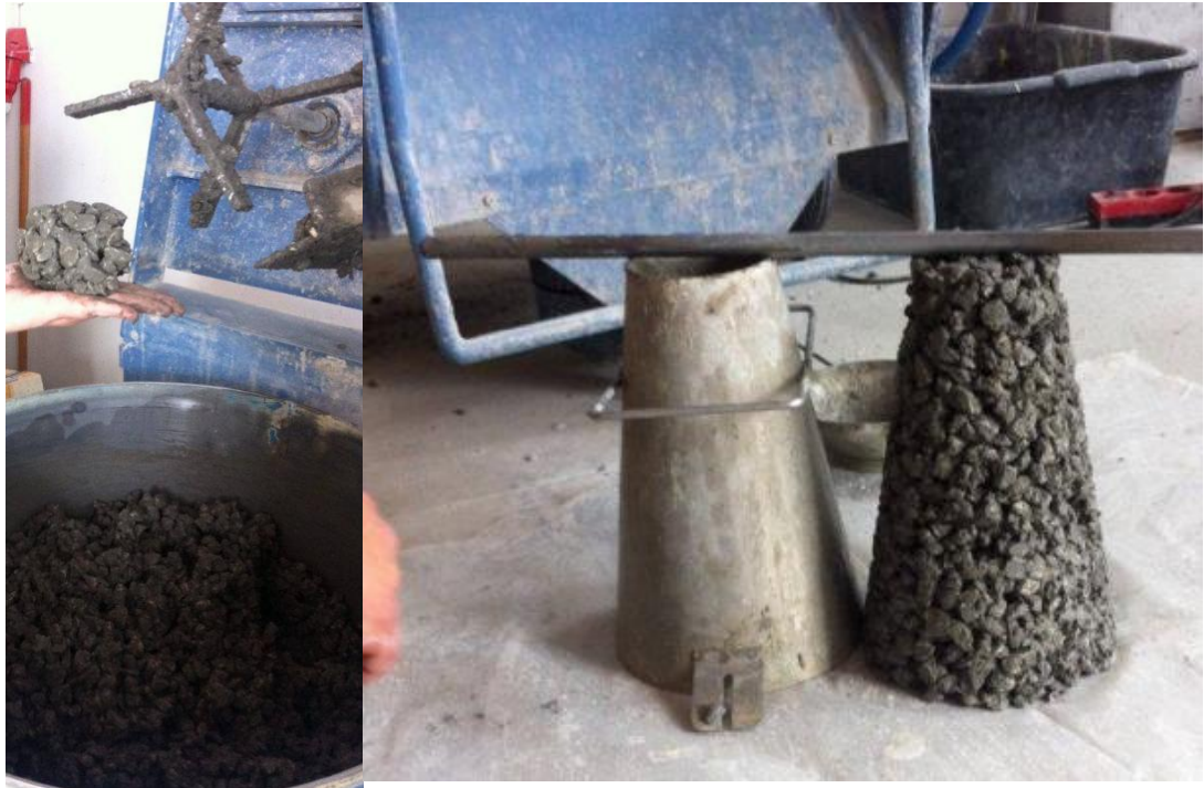
Slika 5.2 Ispitivanje konzistencije mješavine P_2 .
