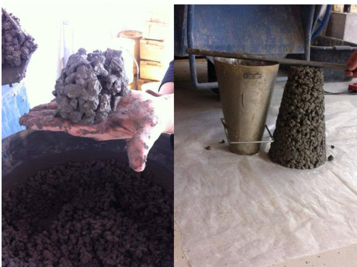
Slika 5.1 Ispitivanje konzistencije mješavine P_1
