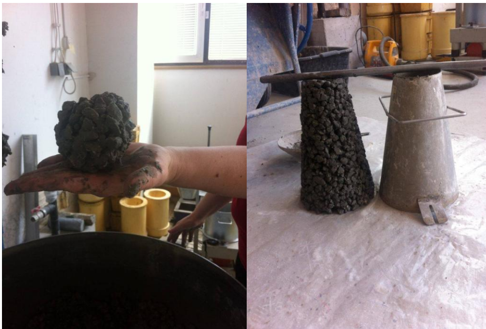
Slika 4.7 Ispitivanje konzistencije metodom oblikovanja kuglice i metodom slijeganja
