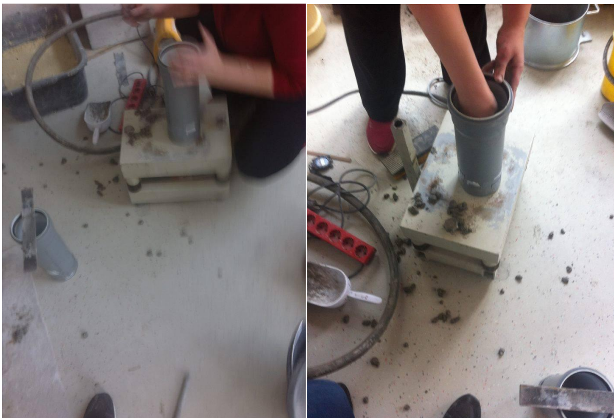
Slika 4.6 Ugradnja mješavina vibriranjem na vibrostolu
