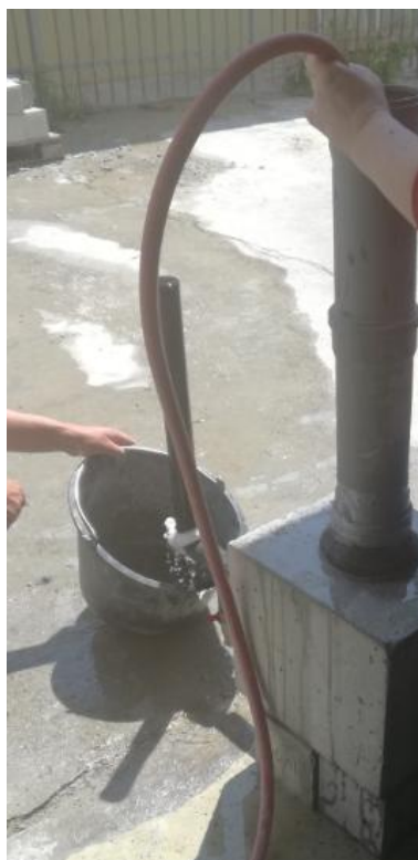
Slika 4.10 Ispitivanje propusnosti metodom stalne razine stupca vode
