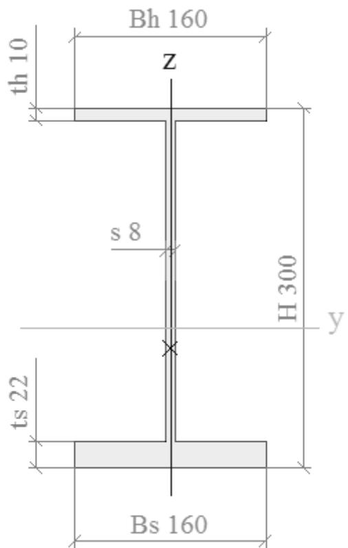
Slika 23. Poprečni presjek sekundarnog-poprečnog nosača
