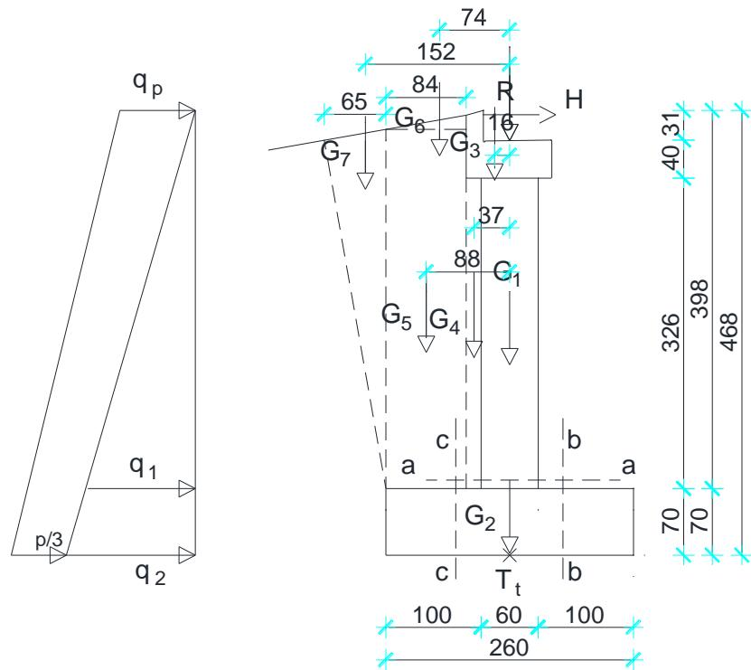
*Slika 31.* Poprečni presjek upornjaka-dimenzije i djelovanje vlasitite težine i tla
