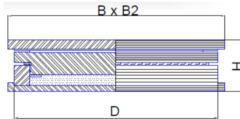
Slika 30. Točkasti ležaj
