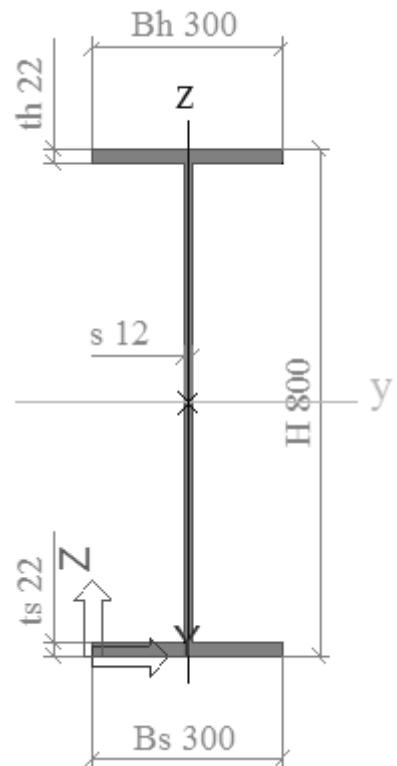
*Slika 19.* Poprečni presjek glavnoguzdužnog nosača
