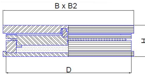
*Slika 29. Jednosmjerno pomican ležaj*
