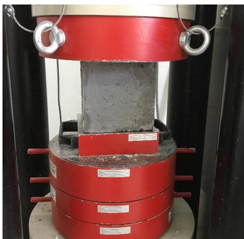
Slika 6.24.: Preša za ispitivanje tlačne čvrstoće betona
