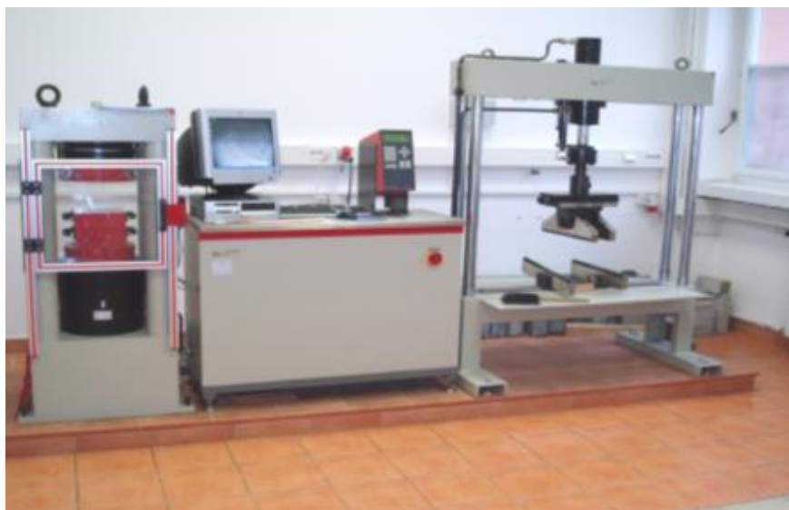
Slika 4.7.: Uređaj za ispitivanje mehaničkih svojstava betona [3]
