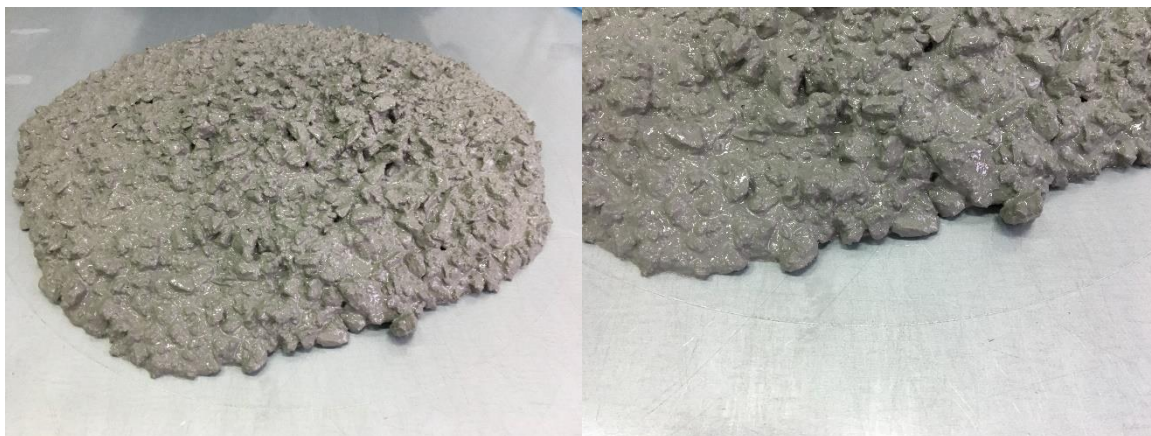
Slika 6.9.: Rasprostiranje mješavine N1 (nema lučenja vode)
