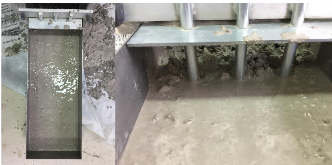
Slika 6.20.: Ispitivanje L – kutijom (mješavina N9)
