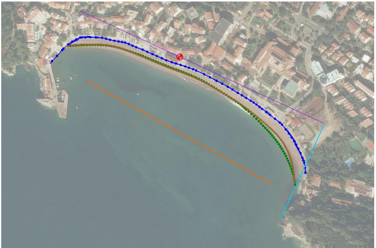
Slika 10.15 Prag širine 150 m sa skaliranim maksimalnim parametrima vala
