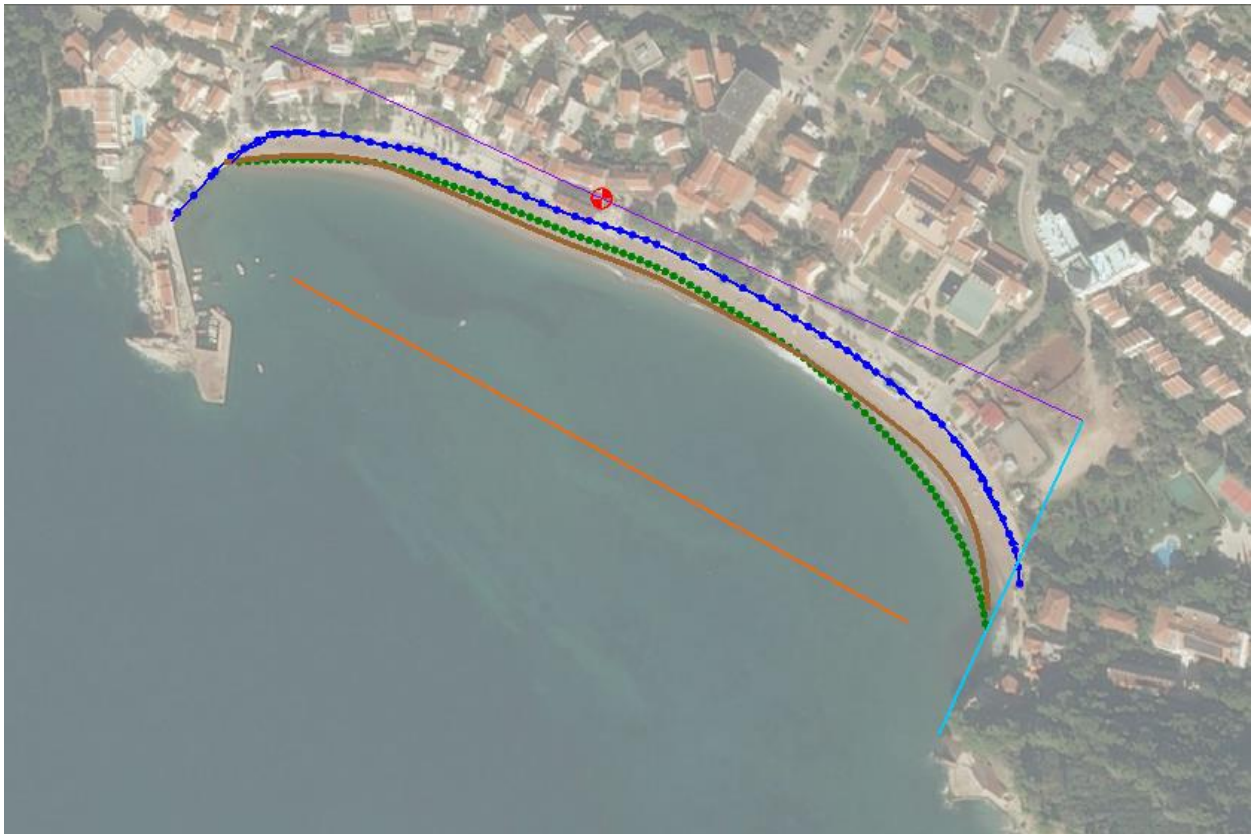
Slika 10.11 Prag širine 150 m sa skaliranim maksimalnim parametrima vala smjera S
