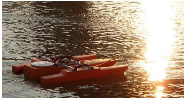
Slika 4.3.: T-RDI akustički Doppler uređaj za mjerenje protoka, ADCP
