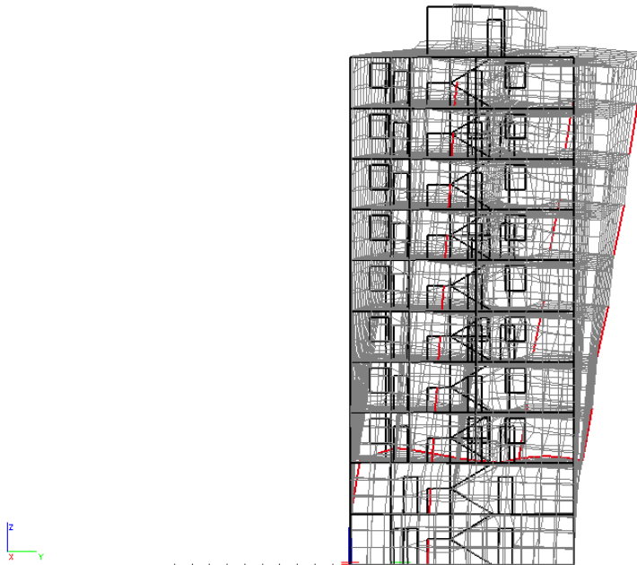
Slika 8.9. Translacija u smjeru globalne osi y - mod 1
