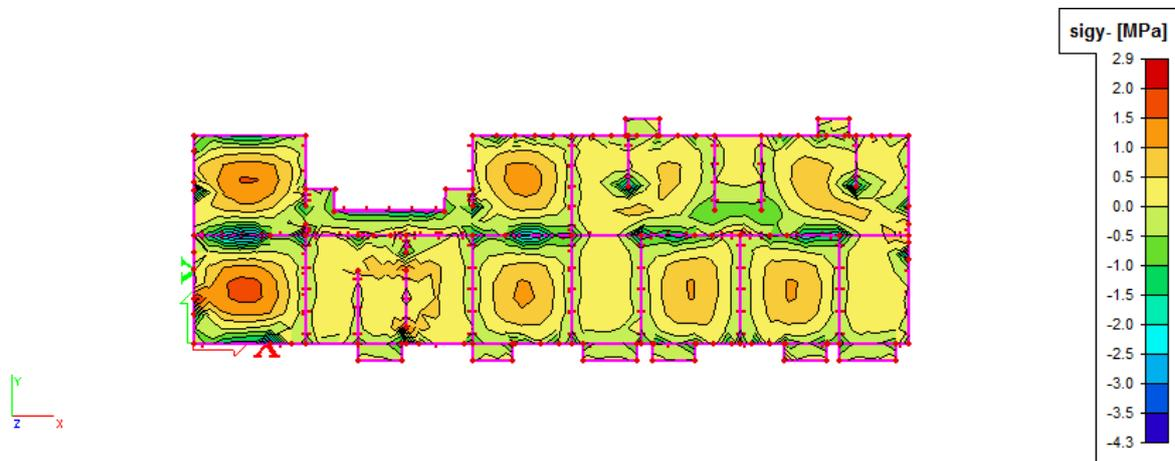
**Crtež 8.9.** Tlačna naprezanja u betonu na donjoj plohi ploče  $\sigma_{c,y,-}$  [MPa] u smjeru Y za nazovistalnu kombinaciju GSU-2:  $1.0 \cdot (G_0+G) + 0.3Q$
