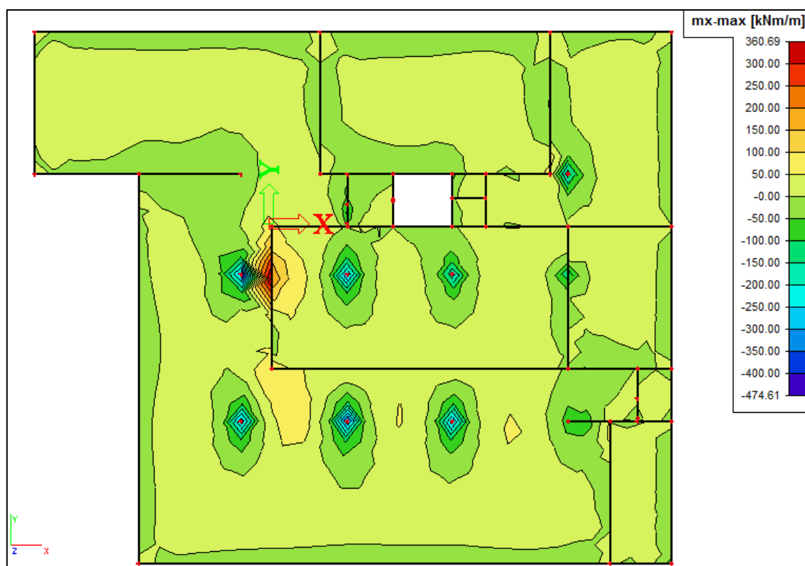
Slika 136. Dijagram momenta savijanja M_x (kNm/m')
