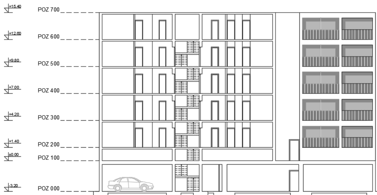
Slika 3. Presjek B-B kompleksa stambenih zgrada
