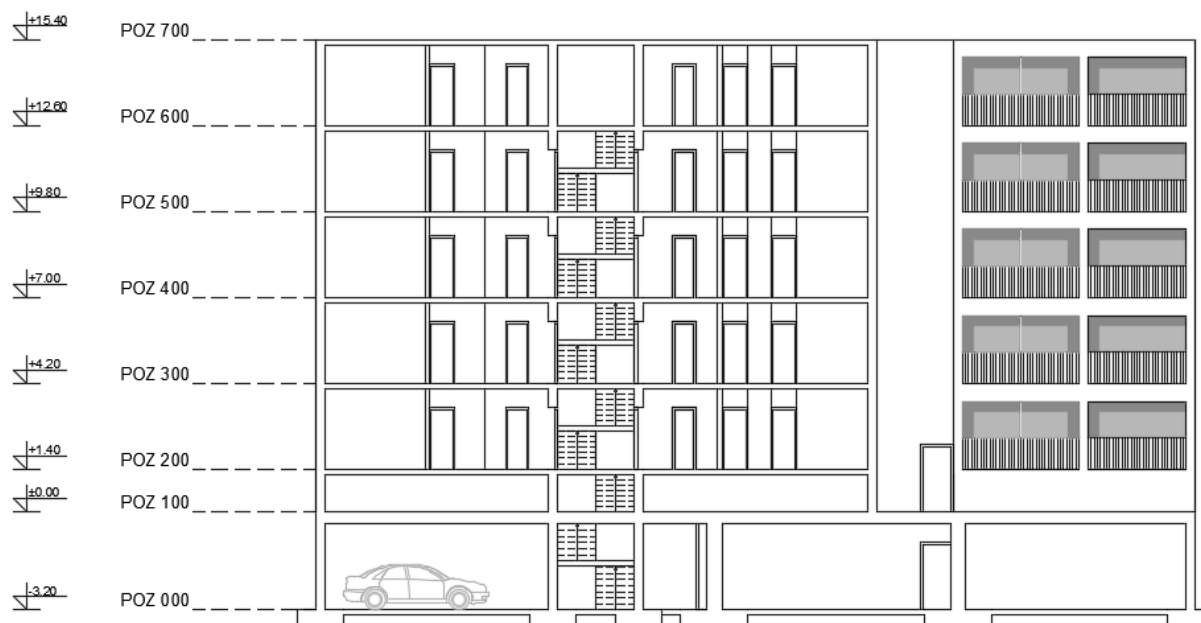
Slika 3. Presjek B-B kompleksa stambenih zgrada
