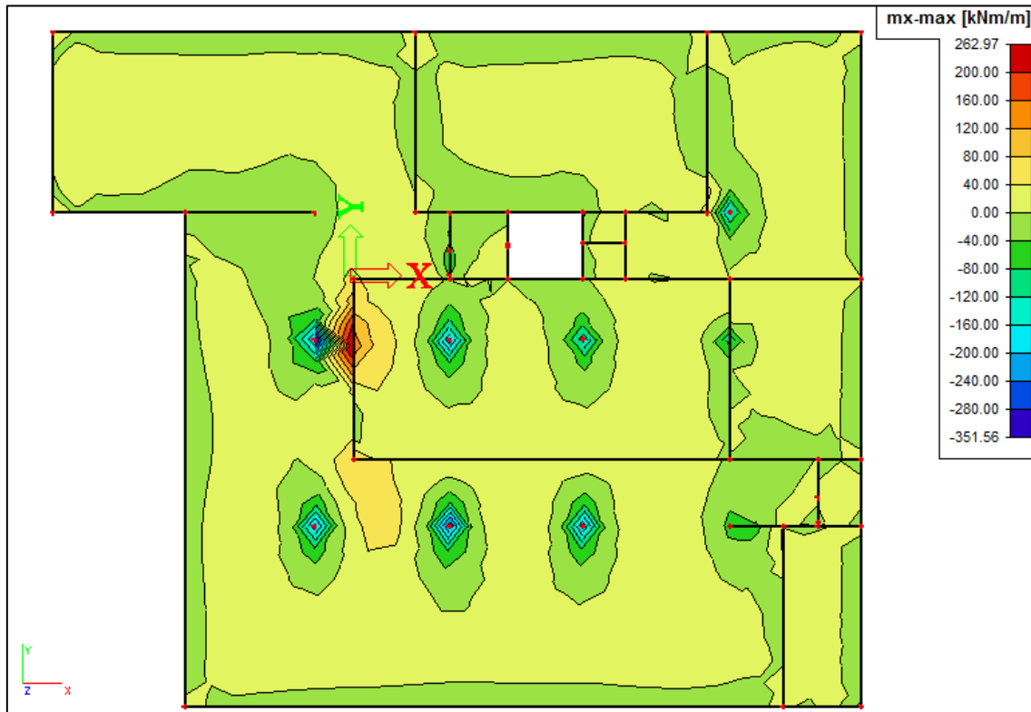
Slika 140. Dijagram momenta savijanja M_x (kNm/m')
