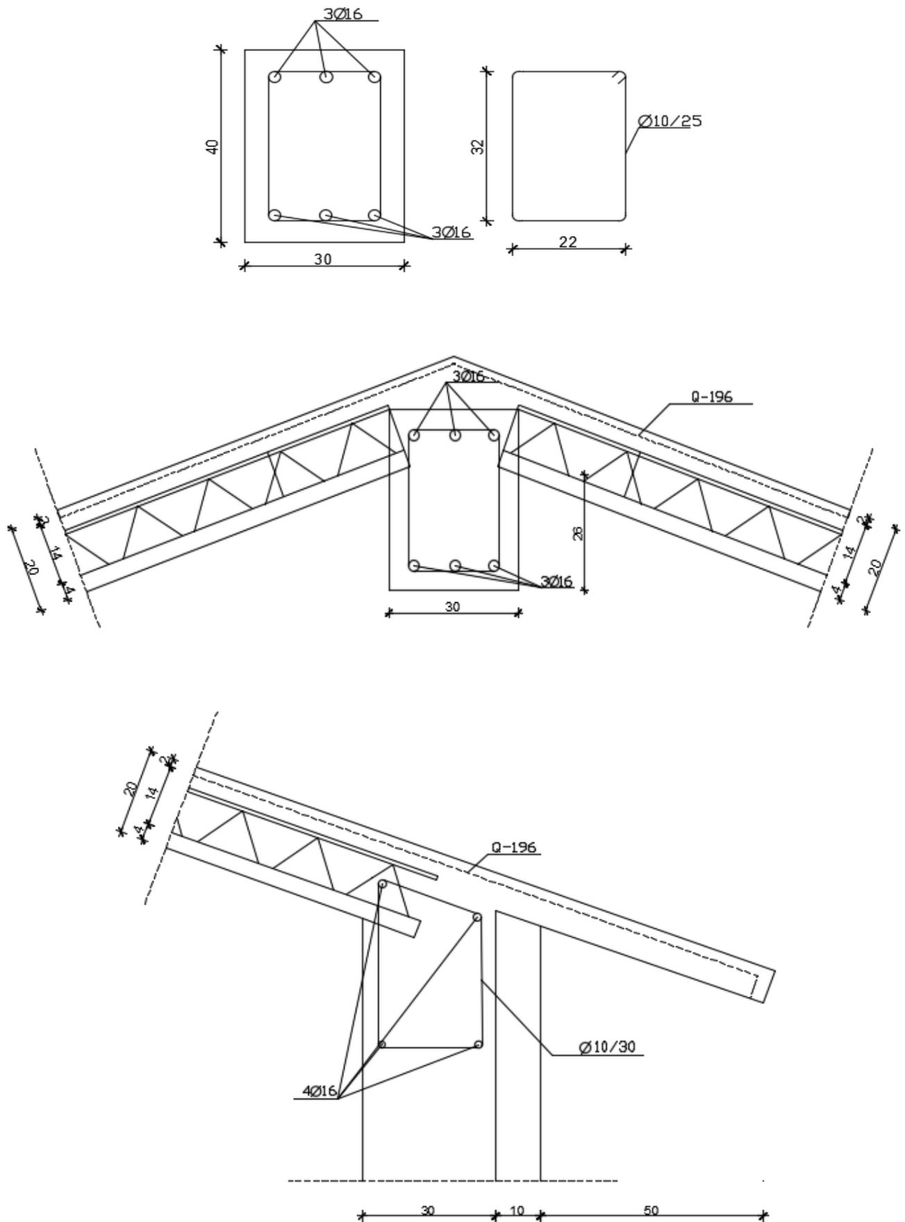
*Napomena:* Zbog raspona i malih momenata savijanja, proračun potrebne armature gređa u prizemlju nije proveden. Za gređe u prizemlju usvojene su dimenzije  $b/h = 30/40$  cm, uzdužna armatura  $4\text{Ø}16$  te poprečna armatura  $\text{Ø}10/30$ .
