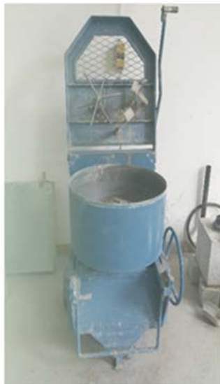
Slika 3.1. Mješalica betona i mješavina [slika zabilježena tijekom ispitivanja].
