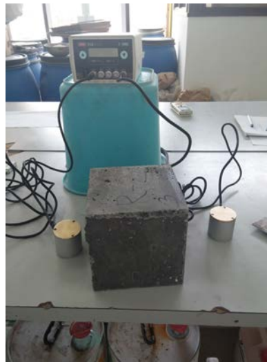
Slika 3.12. Ispitivanje ultrazvukom [slika zabilježena tijekom ispitivanja].
