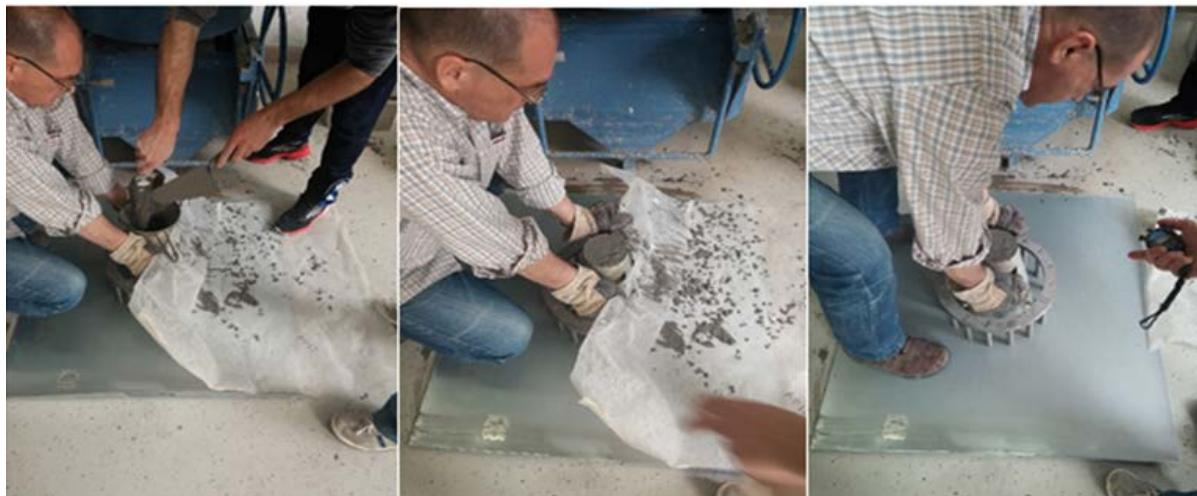
*Slika 3.8. Postupak ispitivanja J-prstenom [slika zabilježena tijekom ispitivanja].*
