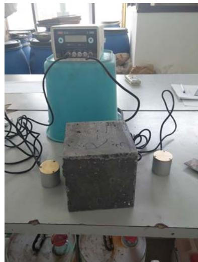
*Slika 3.12. Ispitivanje ultrazvukom [slika zabilježena tijekom ispitivanja].*
