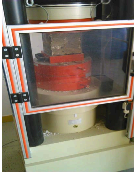
Slika 3.11. Ispitivanje tlačne čvrstoće [slika zabilježena tijekom ispitivanja].
