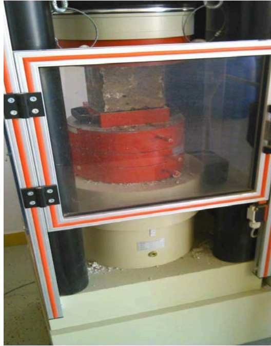
Slika 3.11. Ispitivanje tlačne čvrstoće [slika zabilježena tijekom ispitivanja].
