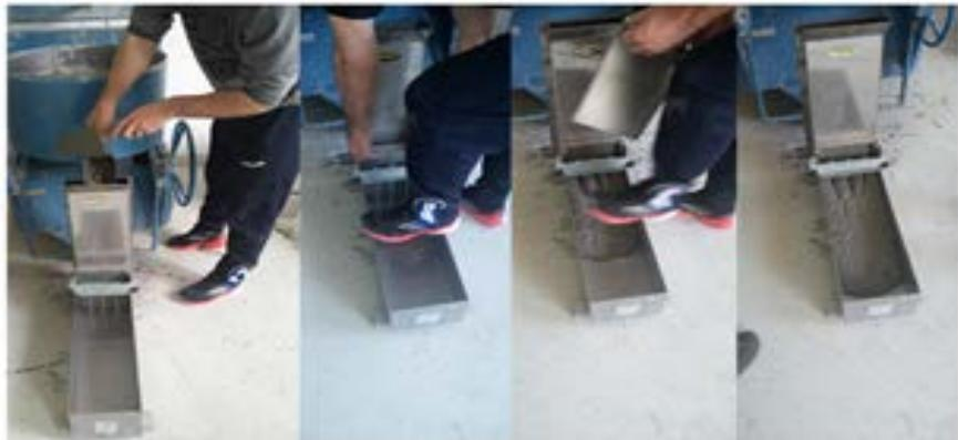
*Slika 3.6. L- box uređaj [slika zabilježena tijekom ispitivanja].*
