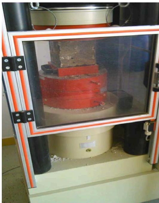
*Slika 3.11. Ispitivanje tlačne čvrstoće [slika zabilježena tijekom ispitivanja].*
