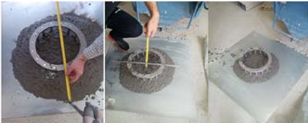
Slika 3.9. Primjeri testiranja J-prstenom (SCC1, SCC2, SCC3) [slika zabilježena tijekom ispitivanja].
