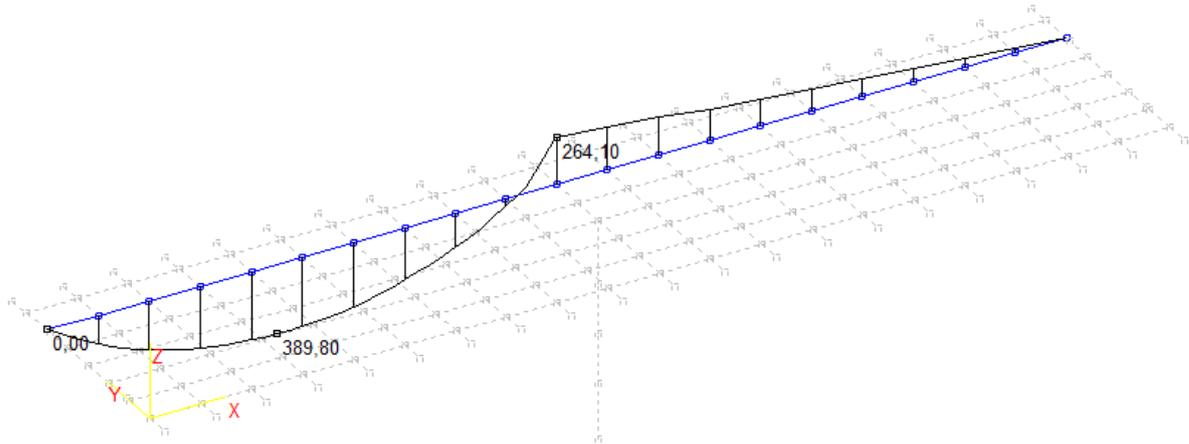
Slika 18.: Pokretno opterećenje – max. Poprečna sila pri stupu – poprečne sile  $T_y$  (Kn)
