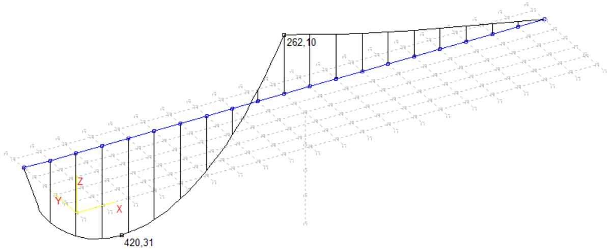
Slika 20.: Pokretno opterećenje - max. poprečna sila pri upornjaku-poprečne sile  $T_y$ (kN)
