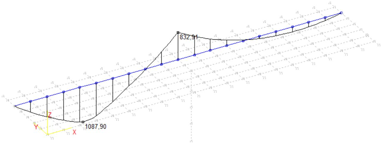
Slika 16.: Pokretno opterećenje – max. momenti pri stupu – poprečne sile  $T_y(\text{kN})$
