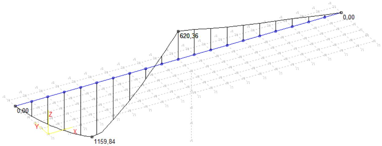
Slika 13.: Pokretno opterećenje – max. moment u prvom polju – poprečne sile  $T_z$  (kN)
