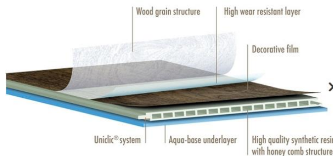
Slika 3. Vodootporni laminat od recikliranog materijala
