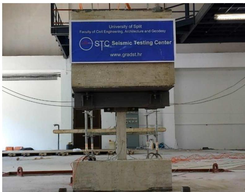
Slika 3.57 Izgled karakterističnog stupa prije ispitivanja
