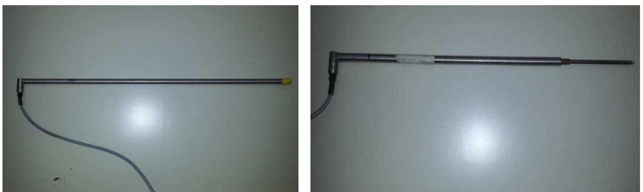
Slika 2.15. Senzori za mjerjenje pomaka
