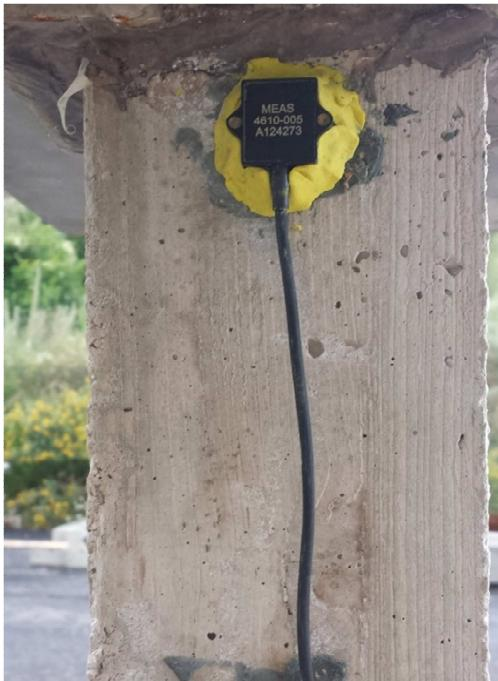
(a) Mjerenje ubrzanja na stupu
