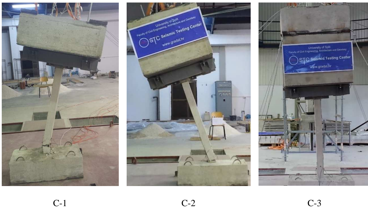
Slika 3.73 Izgled stupova nakon završenog testiranja
