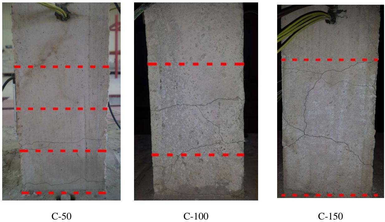
Slika 3.65 Izgled stupova pri dnu nakon završenog testiranja
