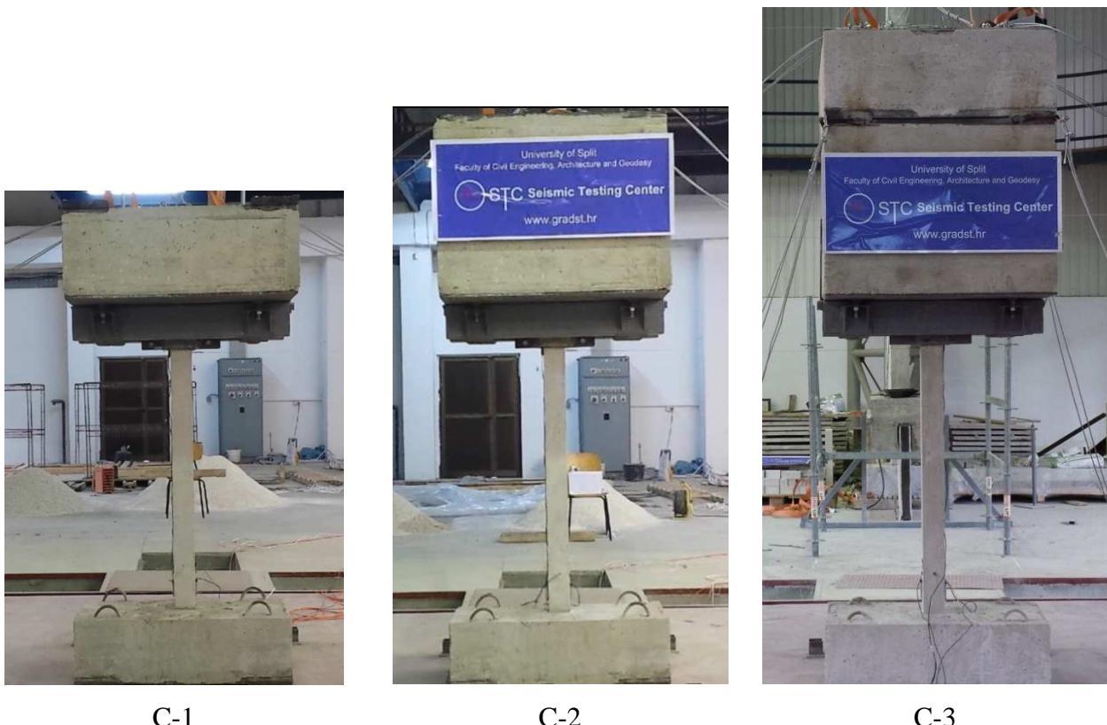
Slika 3.66 Izgled stupova prije ispitivanja
