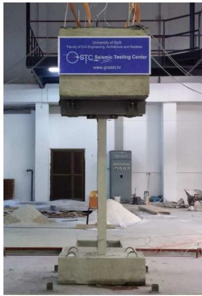
Slika 2.23. Fotografija karakterističnog stupa spremnog za ispitivanje
