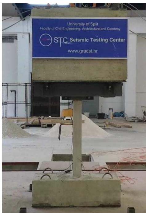
Slika 3.1 Karakteristični stup prije ispitivanja
