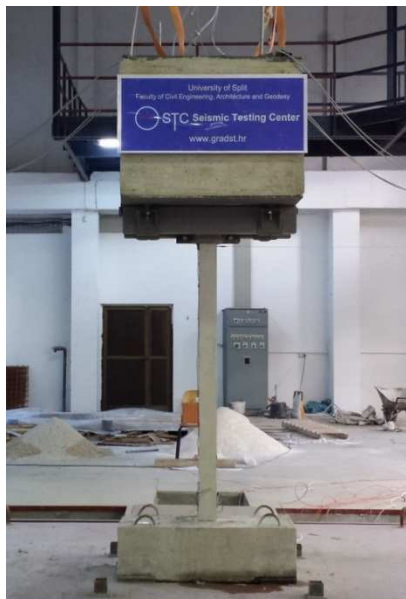
Slika 2.23. Fotografija karakterističnog stupa spremnog za ispitivanje
