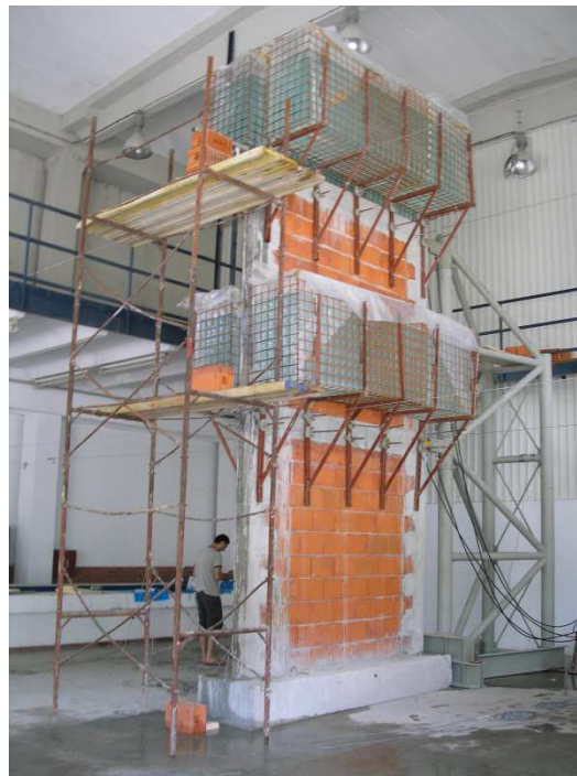
Slika 3.4. Izgled zida MW1, MW2 prije ispitivanja
