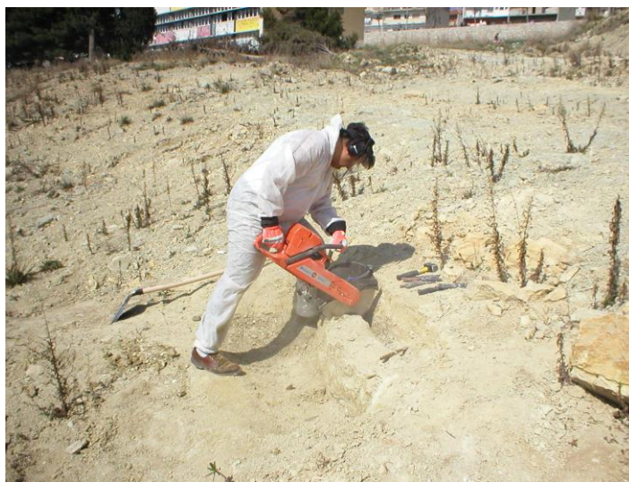
Slika 3.2. Primjer uzorkovanja na terenu upotrebom dijamantne pile
