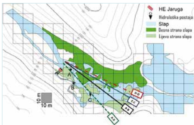
Slika 1: Situacija SB-a na kojoj su naznačeni položaji: hidroloških postaja Nacionalni park (A), Skradinski buk gornji (C) i zahvat vode za HE Jaruga (B), položaj HE Jaruga, 4 poprečna presjeka (A-A; B-B; C-C; D-D)
