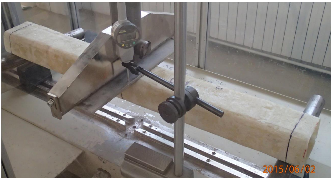
Fotografija 2.10 Prikaz opterećivanja grede G-1
