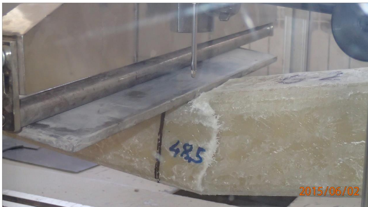
Fotografija 2.17 Prikaz pukotina
