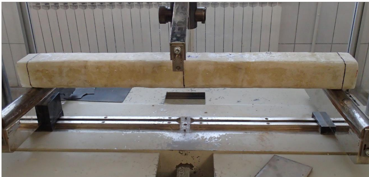
Fotografija 2.2 Prikaz simulacije rubnih uvjeta
