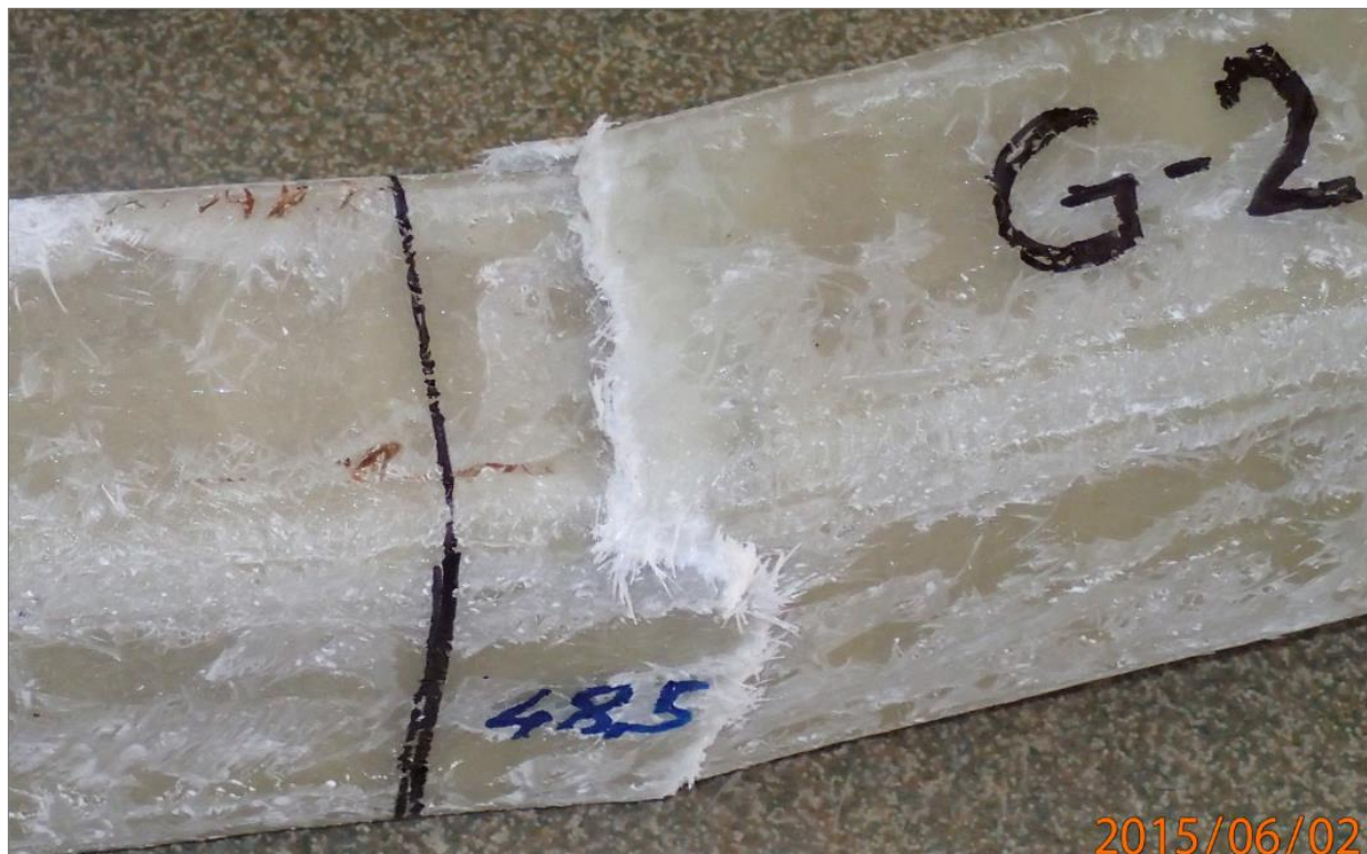
Fotografija 2.19 Prikaz pukotina
