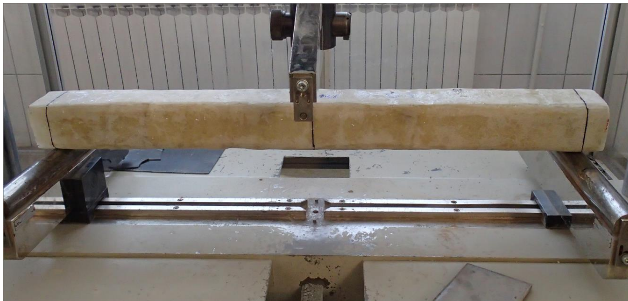
Fotografija 2.2 Prikaz simulacije rubnih uvjeta
