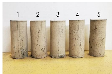
Slika 2. \sigma - \varepsilon krivulje za normalan beton bez gume (RNC-0-500) i normalan beton sa 10%, 20%, 30% i 40% GG; b) Ispitani betonski valjci
