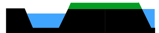
iskopana zemlja iskorištena je za izgradnju nasipa na postojećem terenu (nasip na odgovara visini +2,5 n.m.v što je visina platoa luke Ploče
