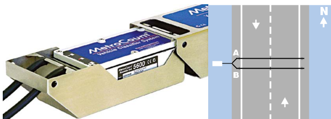
Slika 3.1. Slika brojila MetroCount 5600 i shematski prikaz postavljanja [W.1]
