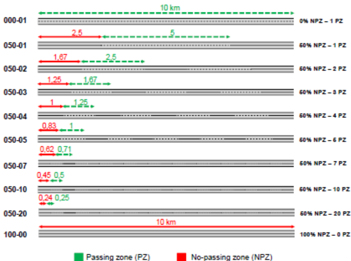
Slika 2.17. Analizirane duljine i raspored zona za pretjecanje [M.2]
