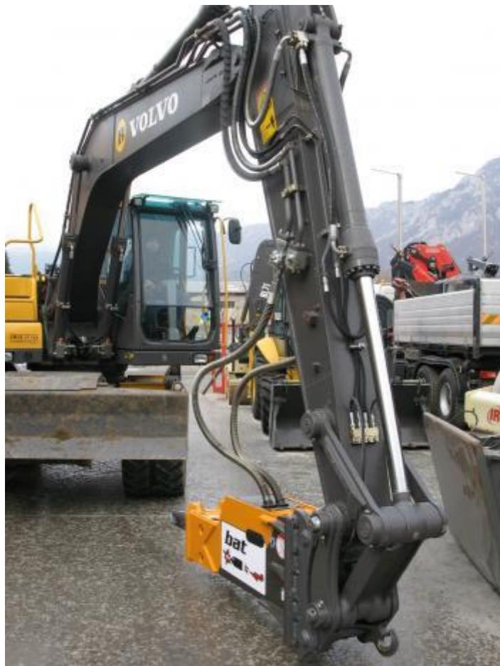
Slika 3.5. Bat hidraulični čekić
