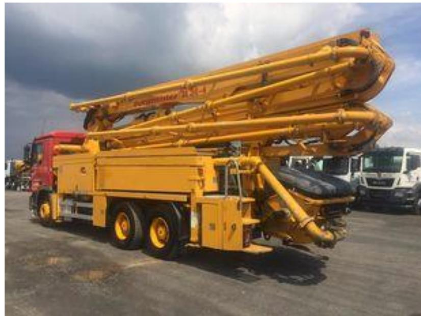
Slika 3.11. Pumpa za beton Mercedes-Benz Actros 2641
