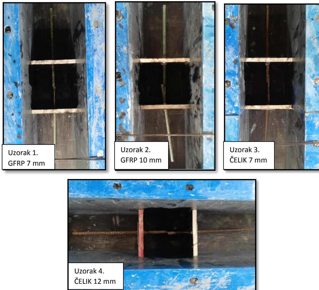
Slike 53. Priprema uzoraka za ispitivanje
