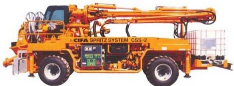
Slika 14. Stroj za izvedbu mlaznog betona [12]
