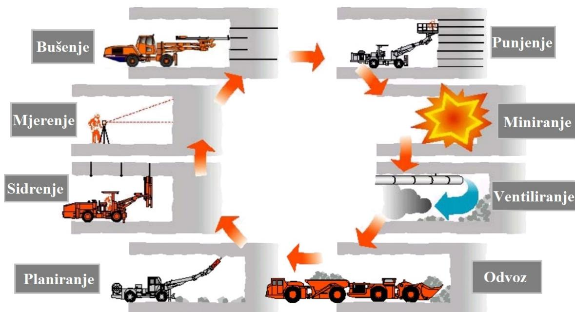
Slika 4. Tehnologija iskopa tunela bušenjem i miniranjem [4]
