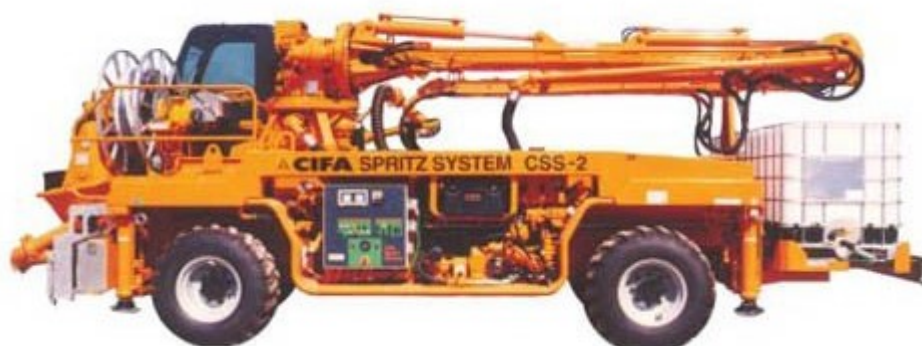
Slika 14. Stroj za izvedbu mlaznog betona [12]
