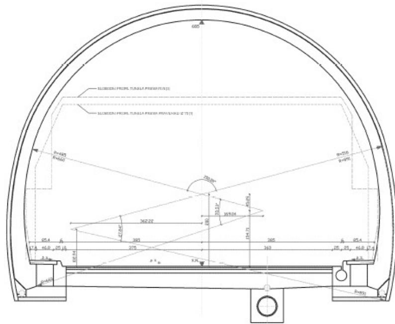
Slika 3. Karakteristični poprečni presjek tunelske cijevi [3]
