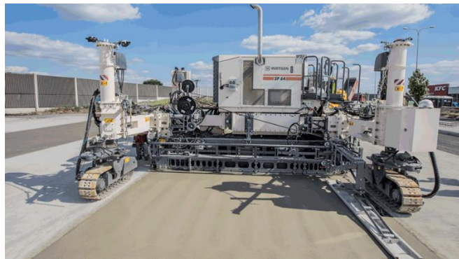
Slika 14. Finišer za beton [15]
