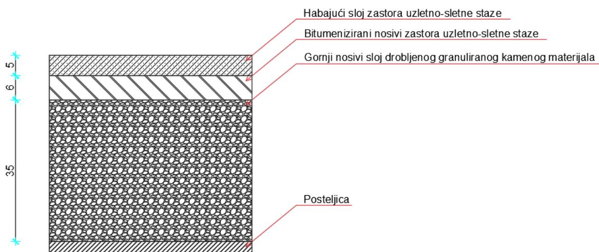
Slika 2. Poprečni presjek tla uzletno-sletne staze
