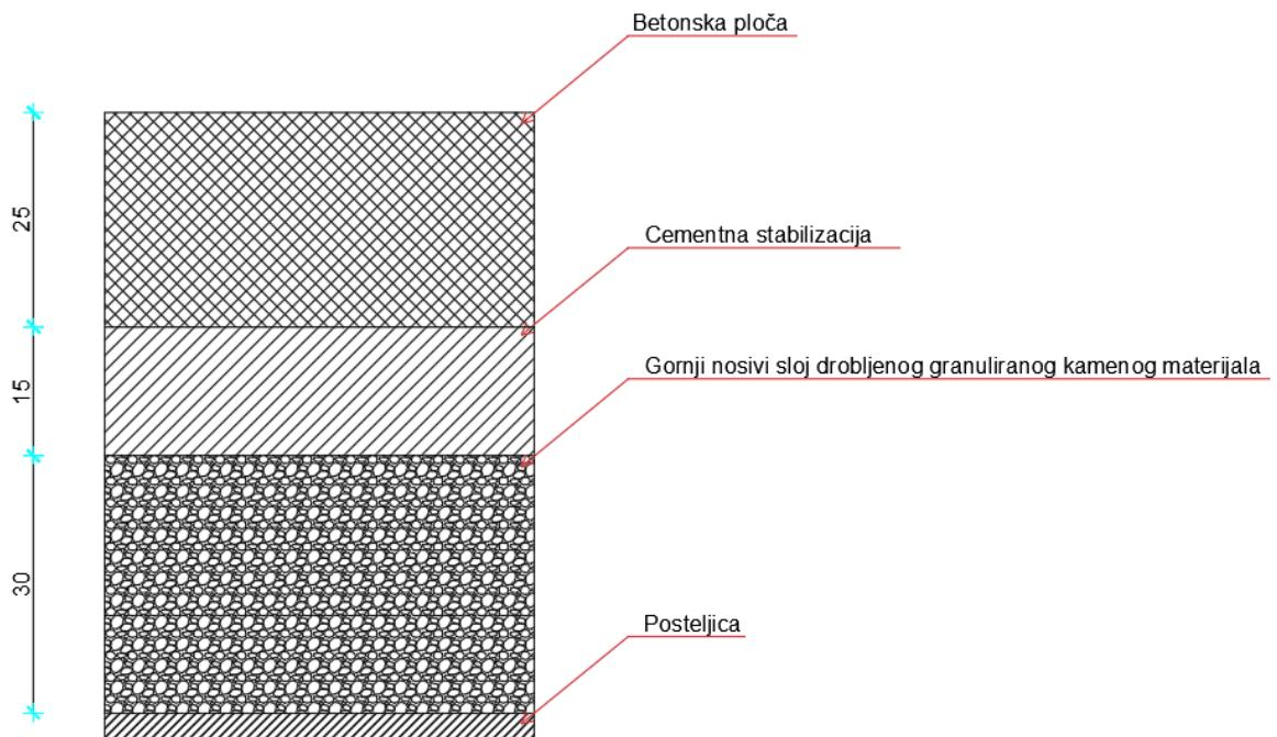
Slika 3. Poprečni presjek tla stajanke i okretišta
