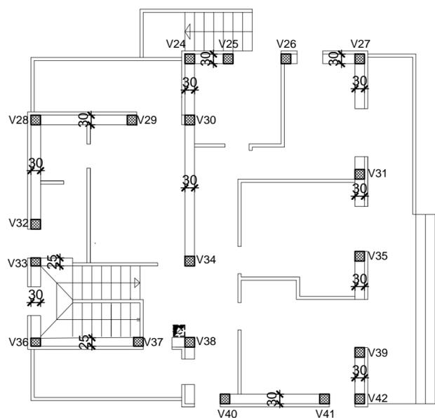
2.3.7. Dovoz, montaža i demontaža oplote za AB vertikalne serklaže.
