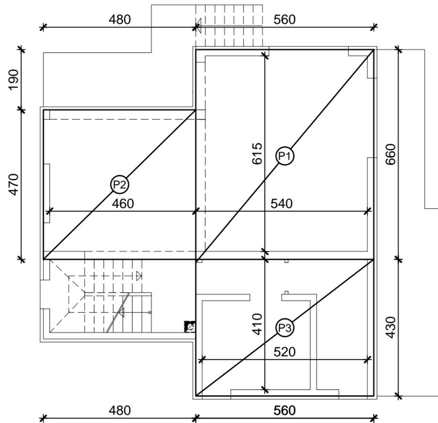
2.3.3. Dovoz, montaža i demontaža oplate za AB međukatnu konstrukciju.
