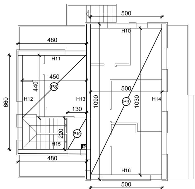
2.3.9.1. Dovož, montaža i demontaža oplate za AB horizontalne serklaže
