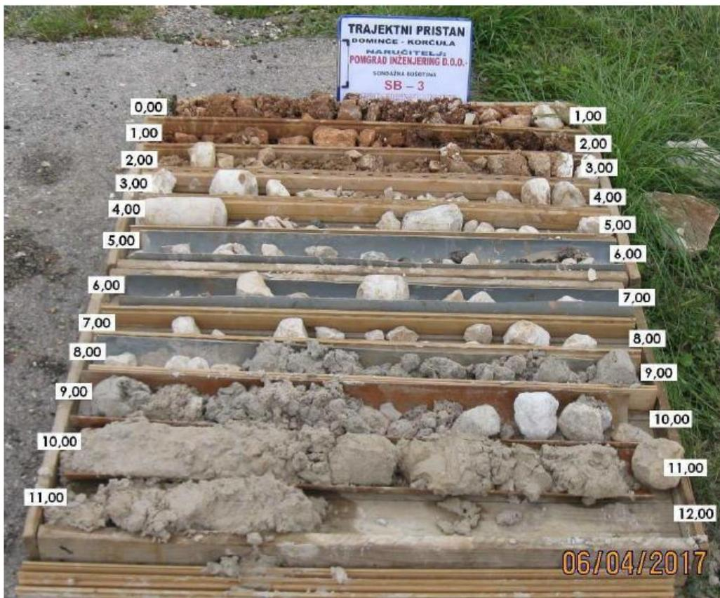
Slika 15. Profil tla iz presjeka A-A
