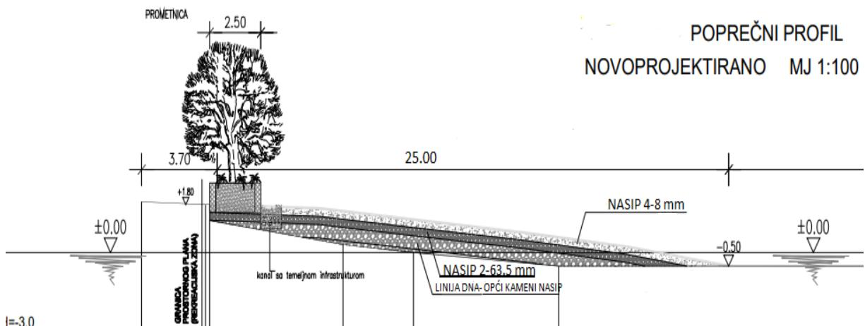
Slika 9. Novoprojektirano stanje, poprečni presjek po uzoru na [7]
