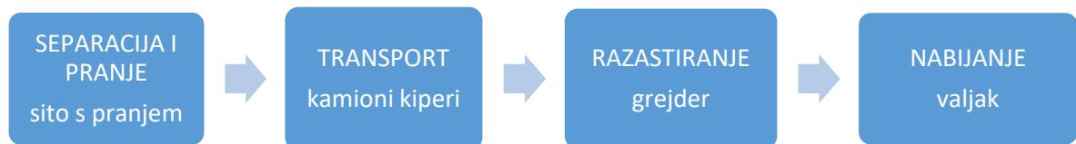
Slika 9. Slijed aktivnosti sa pripadajućim strojevima
