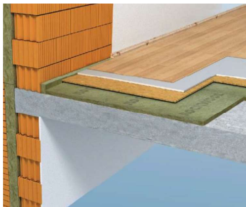
Slika 3.1 Shema međukatne konstrukcije
