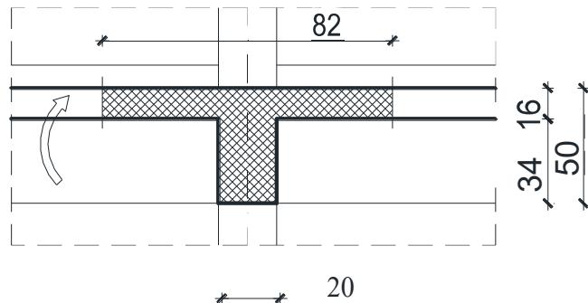
Slika 8.3 Poprečni presjek grede (polje1)
