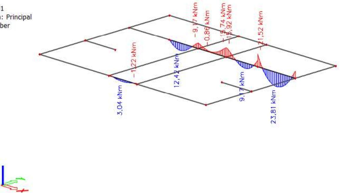
Slika 8.11 Moment savijanja  $M_{Ed,y}$  (kNm) za GSU-1
