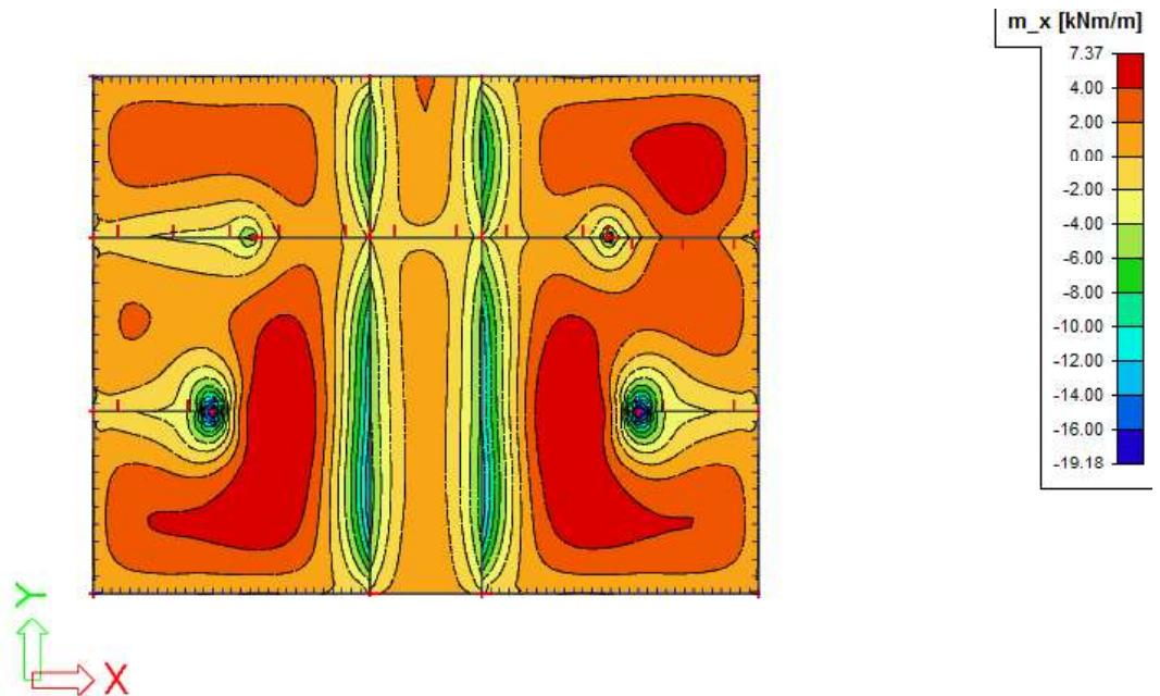
Slika 7.12 Moment savijanja  $M_{Ed,x}$  (kNm/m) za GSU-I
