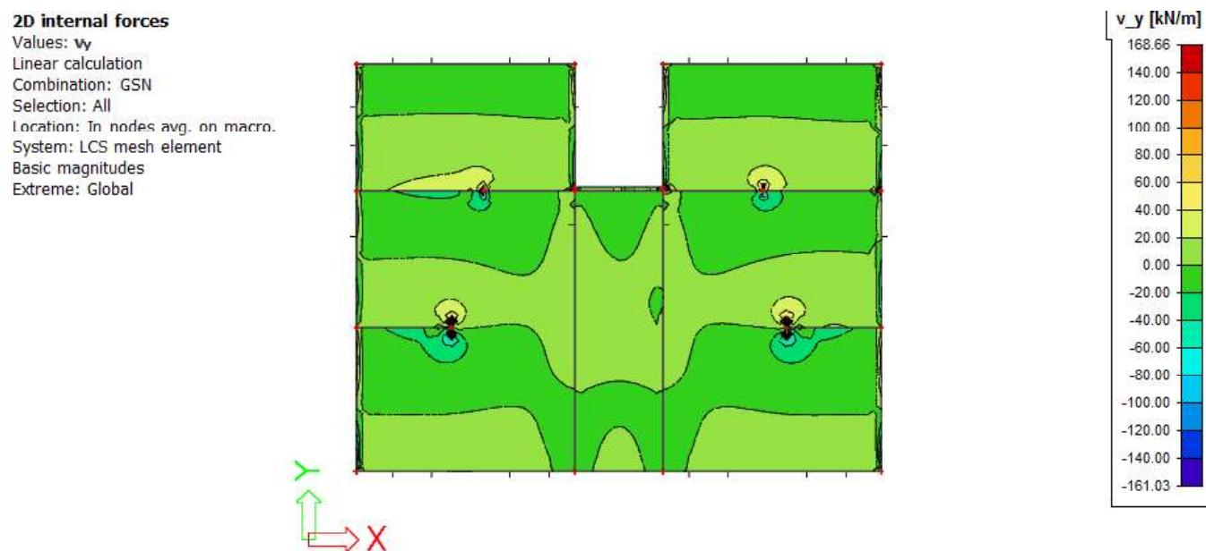
Slika 6.6 Poprečne sile  $V_{Ed,y}$  (kN/m) za GSN-1
