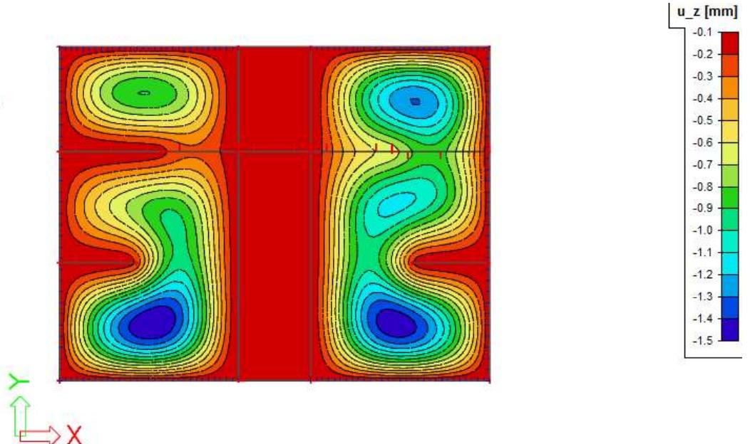
Slika 7.11 Progib ploče (mm) za kombinaciju GSU-2
