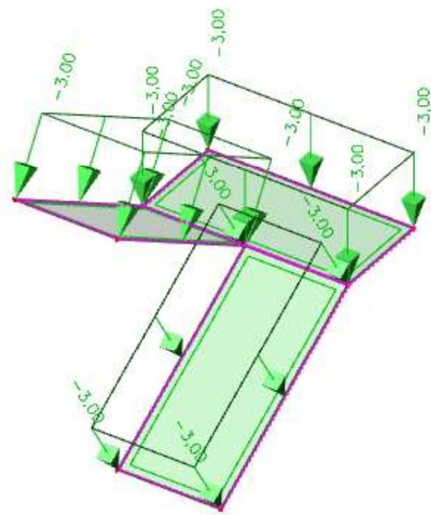
Slika 4.6 Promjenjivo djelovanje  $Q(\text{kN/m}^2)$
