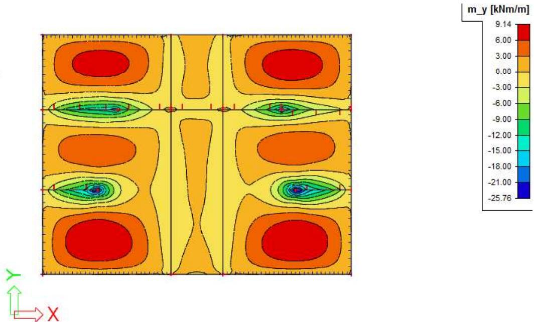
Slika 7.13 Moment savijanja  $M_{Ed,y}$  (kNm/m) za GSU-I
