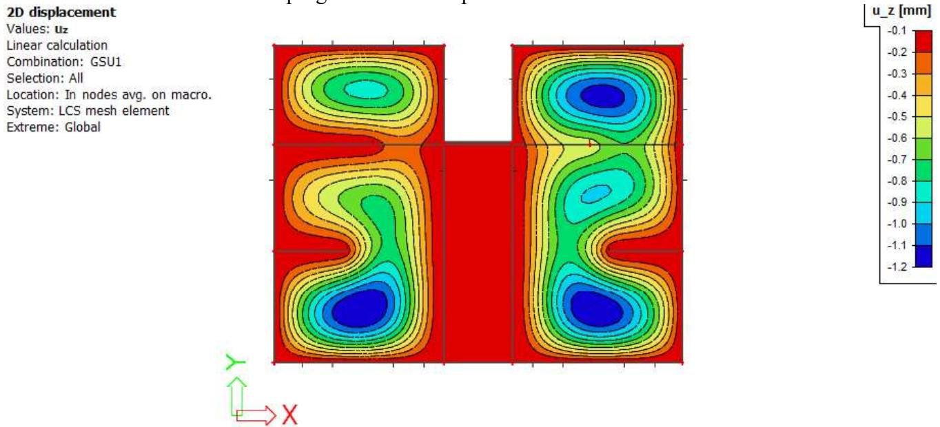
Slika 6.10 Progib ploče (mm) za kombinaciju GSU-1
