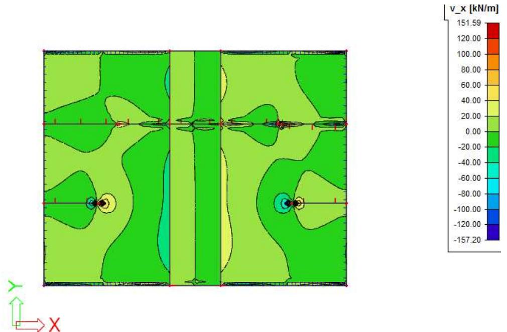
*Slika 7.4 Poprečne sile  $V_{Ed,x}$  (kN/m) za GSN-I***2D internal forces**Values:  $v_y$
