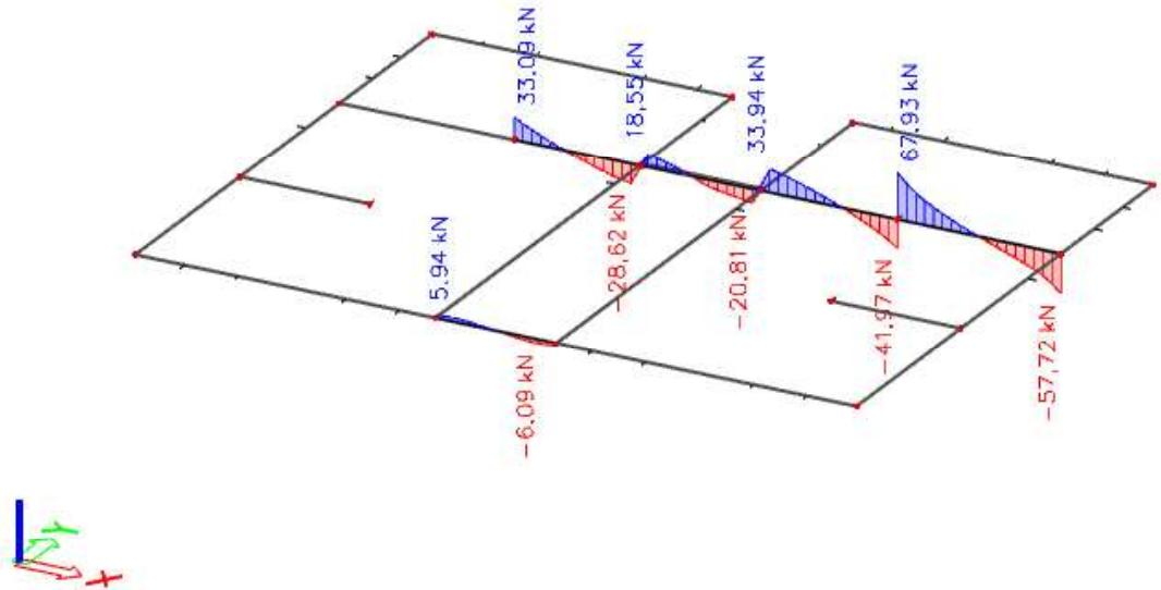
Slika 8.2 Poprečne sile  $V_{Ed,z}$  (kN) za GSN-I
