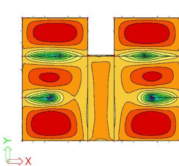
*Slika 6.8 Armatura u ploči smjer  $As,y-y$  ( $\text{cm}^2/\text{m}$ ) za GSN-1*
