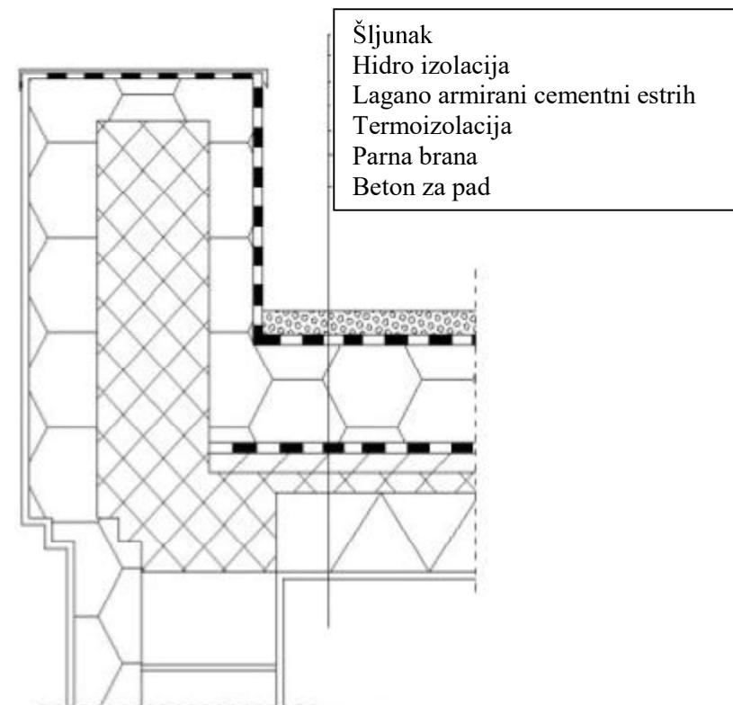
Slika 3.2 Grafički prikaz slojeva konstrukcije neprohodnog ravnog krova
