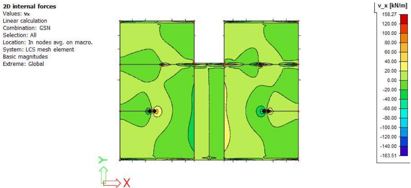
Slika 6.5 Poprečne sile  $V_{Ed,x}$  (kN/m) za GSN-1
