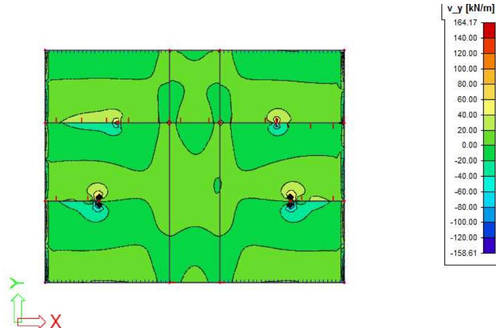
*Slika 7.5 Poprečne sile  $V_{Ed,y}$  (kN/m) za GSN-I*
