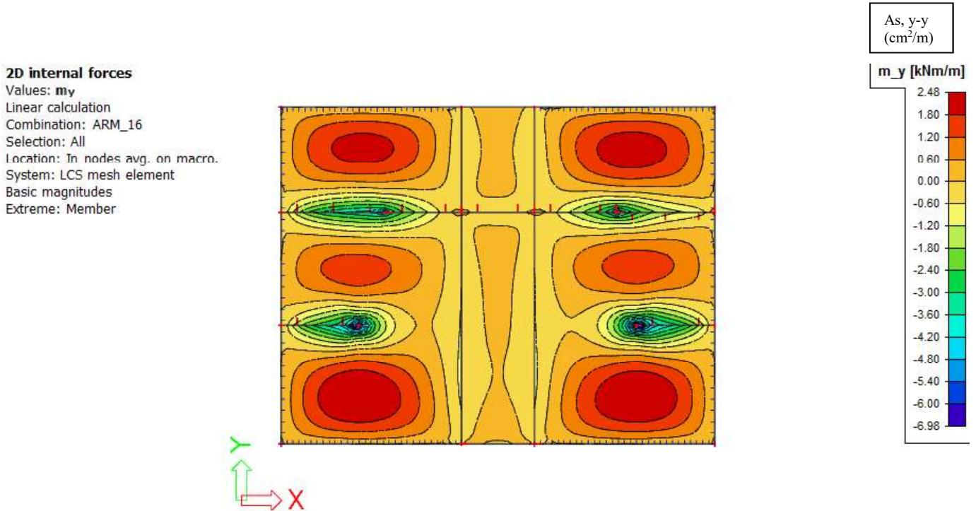
Slika 7.7 Armatura u ploči smjer  $As,y-y$  ( $\text{cm}^2/\text{m}$ ) za GSN-I
