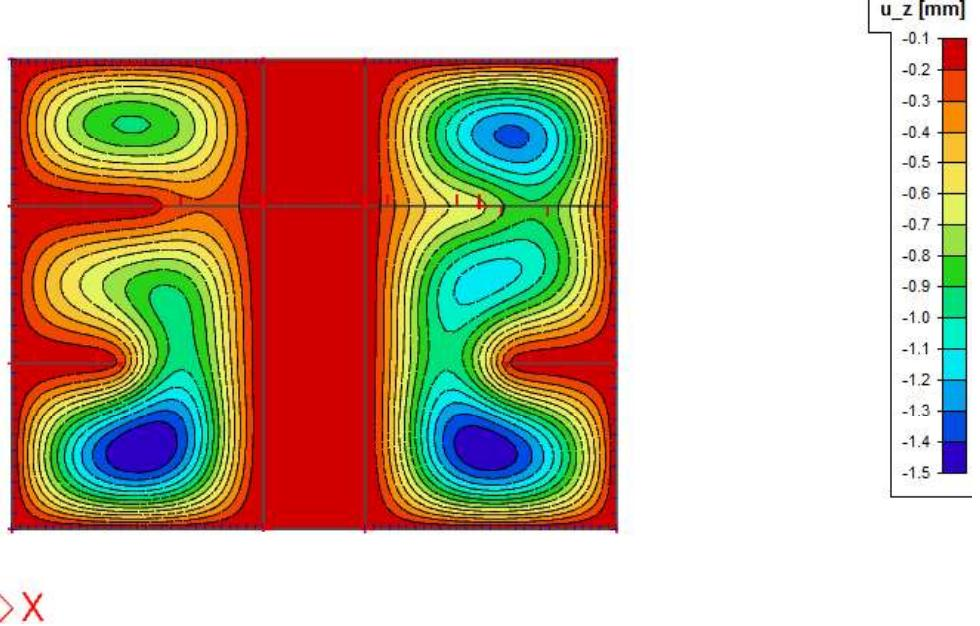
Slika 7.10 Progib ploče (mm) za kombinaciju GSU-1
