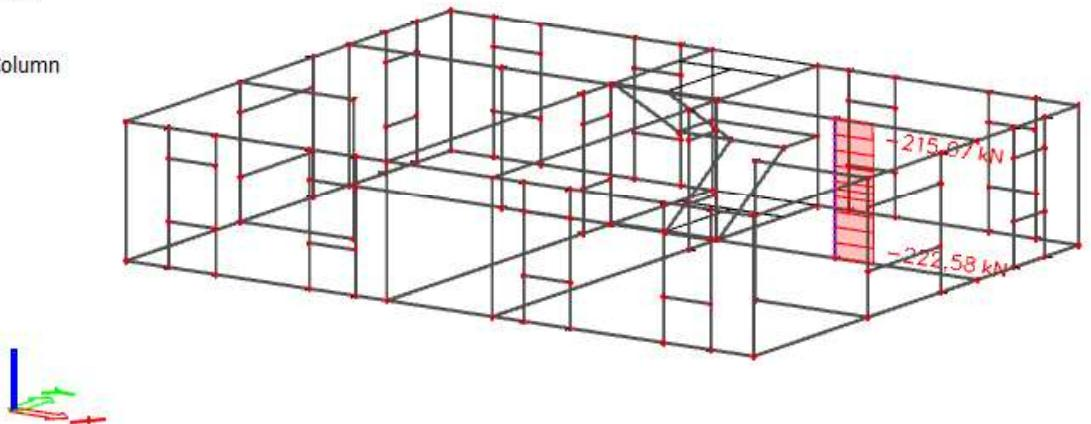
Slika 9.1 Uzdužne sile u stupovima  $N_{Ed}$  (kN) za GSU-2
