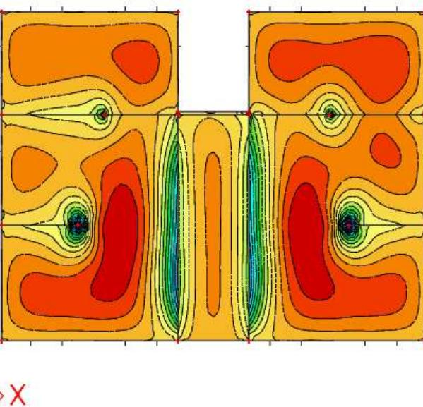
*Slika 6.7 Armatura u ploči smjer  $As,x-x$  ( $\text{cm}^2/\text{m}$ ) za GSN-1***2D internal forces**Values:  $m_y$
