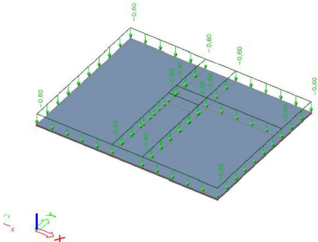
Slika 4.4 Promjenjivo djelovanje  $Q(\text{kN/m}^2)$
