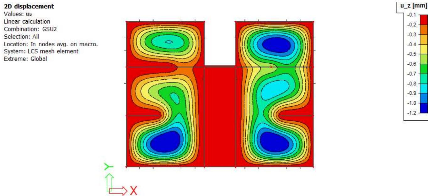
Slika 6.11 Progib ploče (mm) za kombinaciju GSU-2
