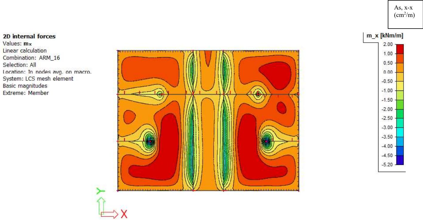
Slika 7.6 Armatura u ploči smjer  $As,x-x$  ( $\text{cm}^2/\text{m}$ ) za GSN-I
