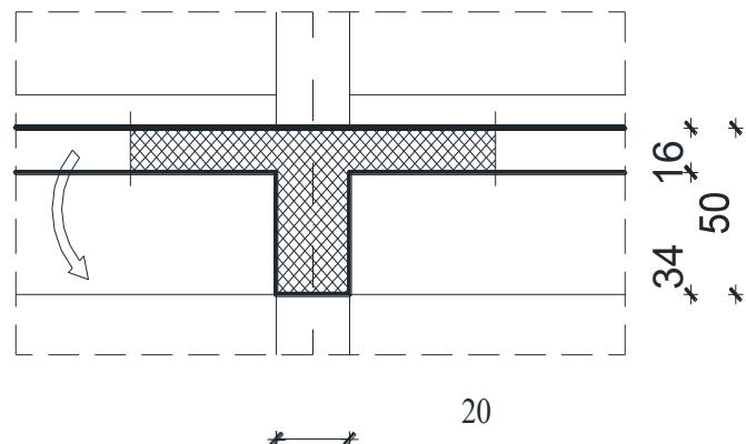
Slika 8.5 Poprečni presjek grede (ležaj)
