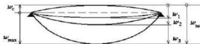
Slika 8.6 Prikaz progiba grede
