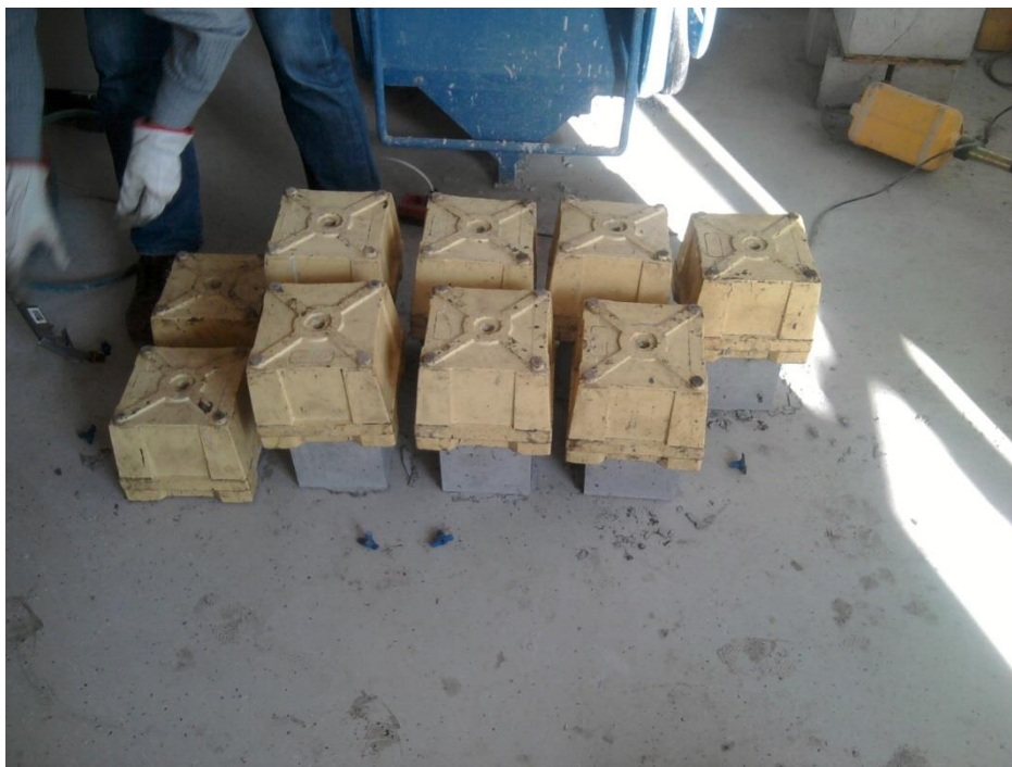
Slika 9.6. Izvađeni uzorci iz kalupa[slika zabilježena tijekom ispitivanja]
