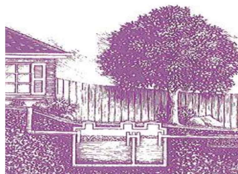
Slika 2.2 Shema dvodjelne septičke jame
