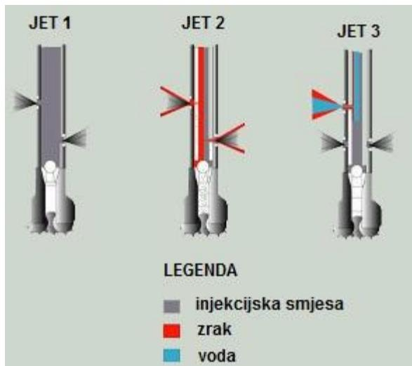
Slika 1. Tri načina izvedbe mlazno injektiranih stupnjaka
