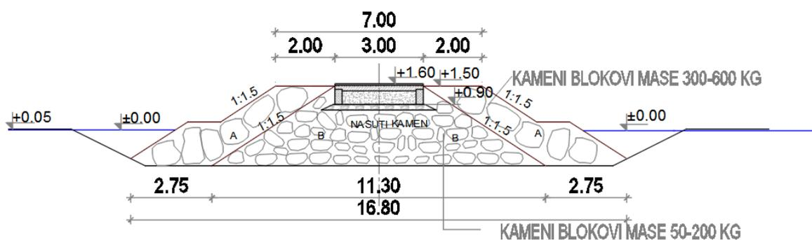
Slika 5.7 Poprečni presjek Pera 1 (Faza 2)
