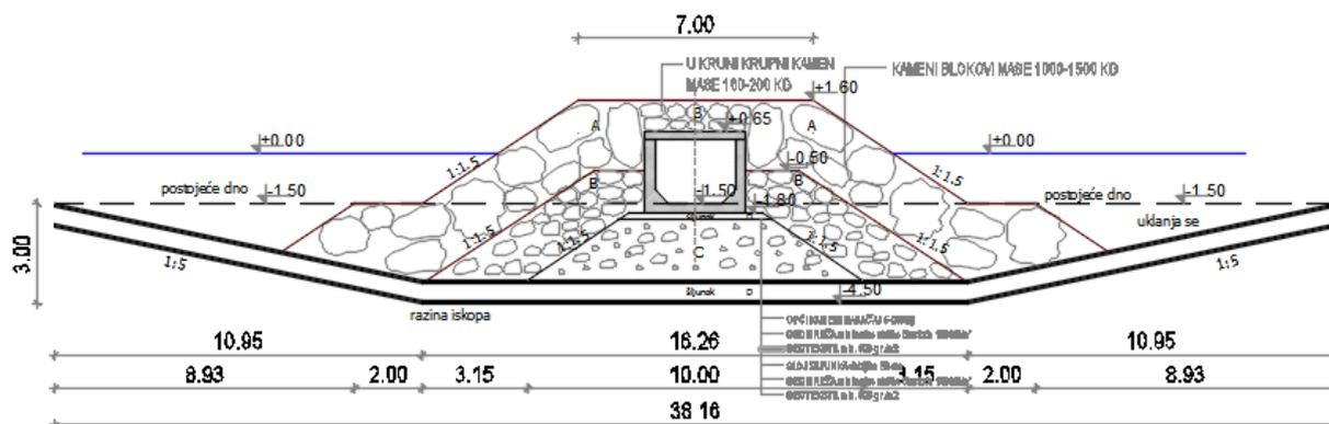
Slika 6.7 Poprečni presjek pera s bujicom Polača
