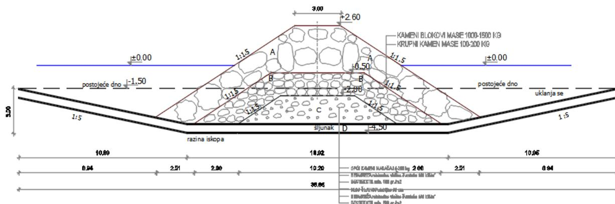
Slika 6.3 Poprečni presjek pera s bujicom Polača – 1. faza
