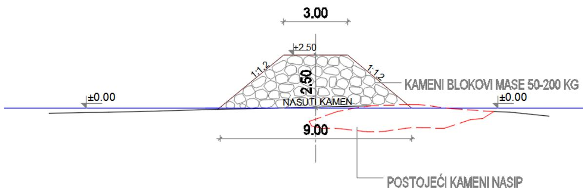
Slika 6.1 Poprečni presjek Pera 1 u prvoj fazi izvedbe
