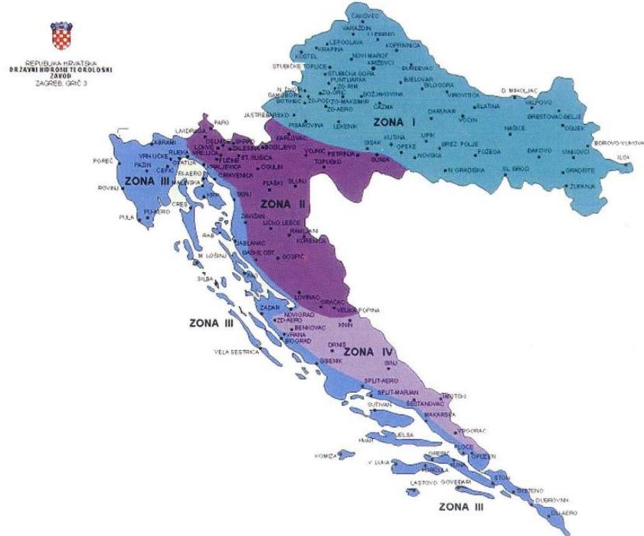
Slika 29. Klimatske zone karakterističnog opterećenja  $s_k$  za razdoblje od 1961. – 1990
