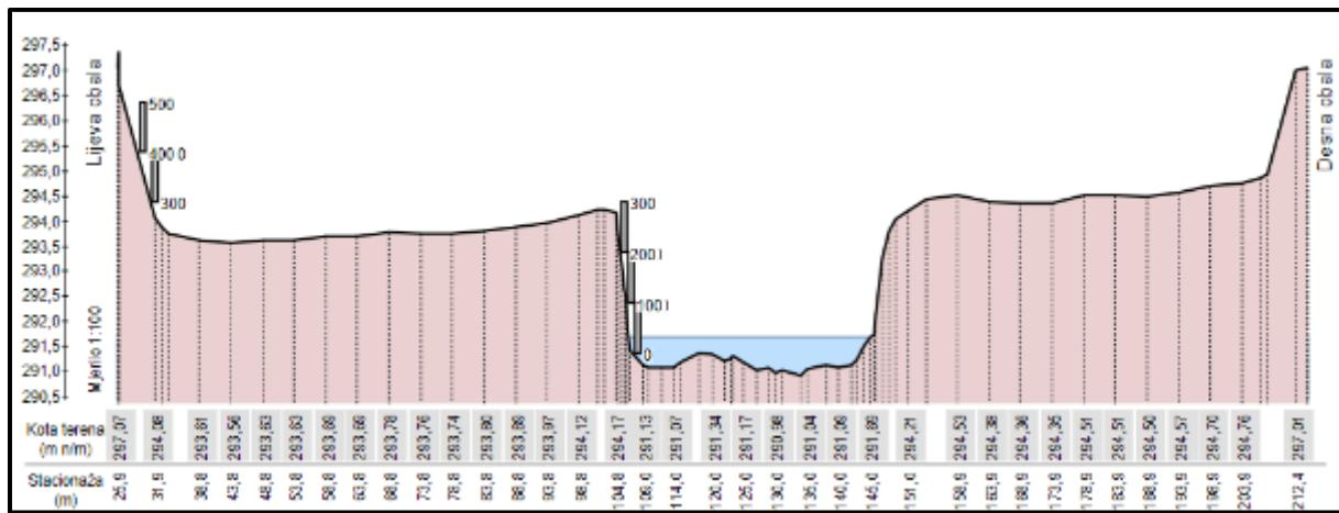
Slika 6. Prikaz poprečnog presjeka vodomjerne postaje Vedrine (DHMZ, 2014)
