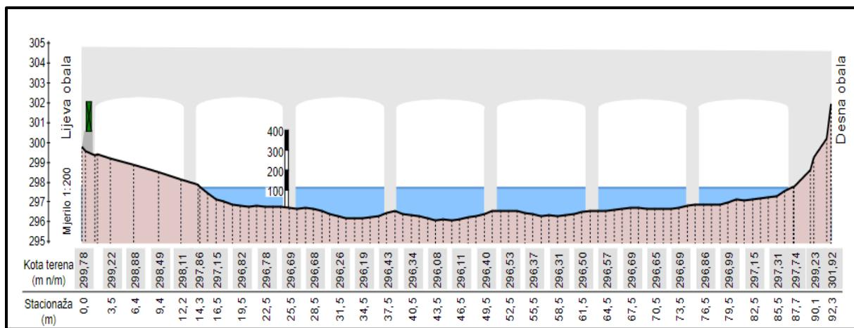
Slika 3. Prikaz poprečnog presjeka vodomjerne postaje Han (DHMZ, 2014)
