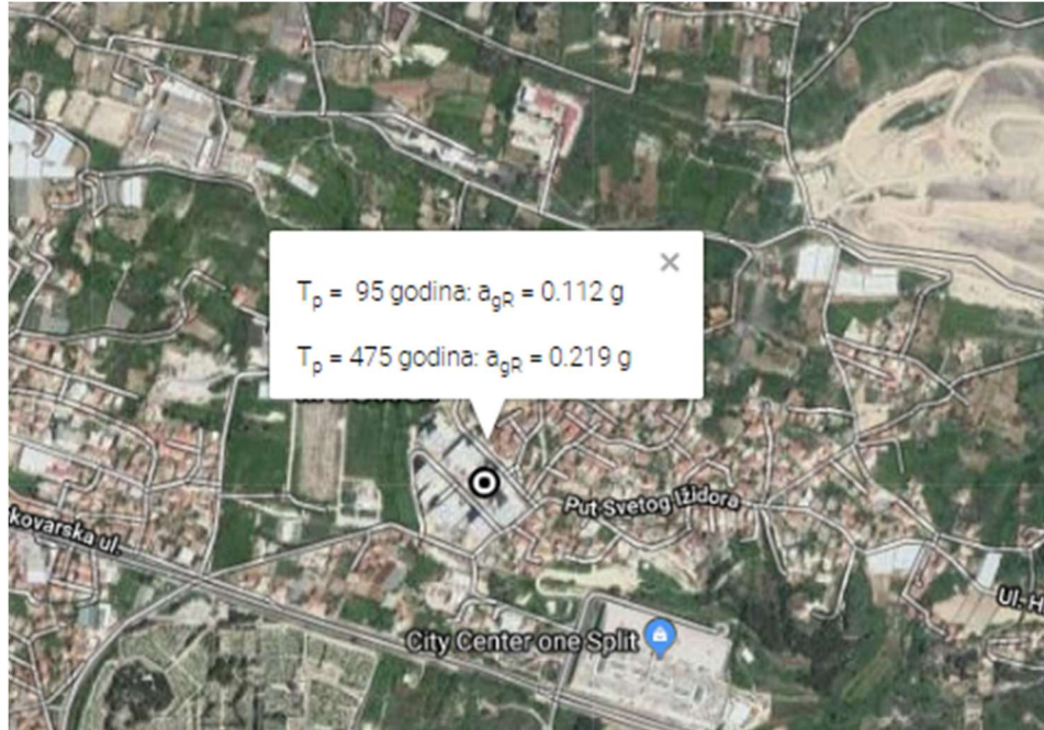
Slika 3.1. Horizontalno vršno ubrzanje tla prema karti iz HRN EN 1998-1:2012/NA
