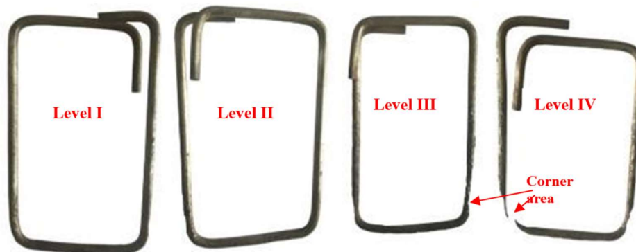
Slika 7.113. Prikaz oštećenja vilica u eksperimentalnim istraživanjima[14]
