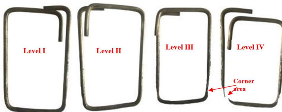
Slika 7.113. Prikaz oštećenja vilica u eksperimentalnim istraživanjima[14]
