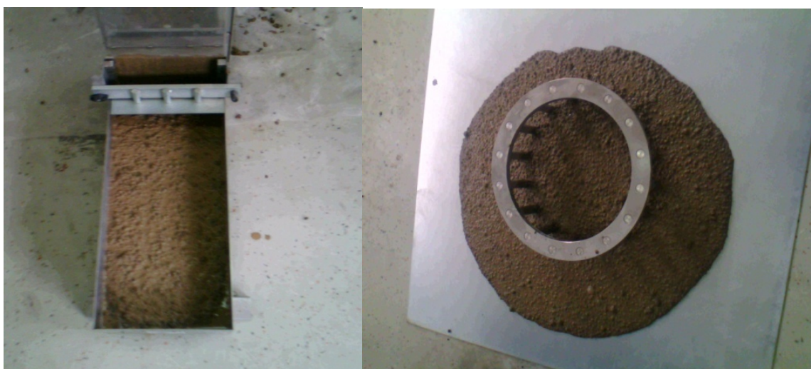
Slika 5.1. Ispitivanje obradivosti u L-box i J-ring [10, 11]
