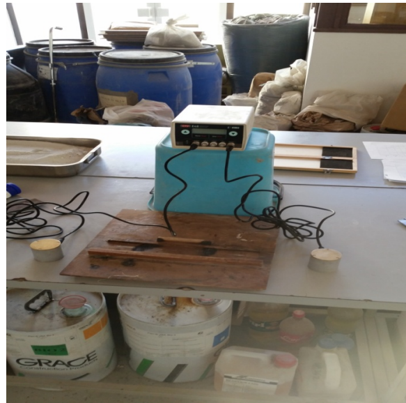
Slika 5.2 Uređaj za mjerenje ultrazvučnih valova [5]
