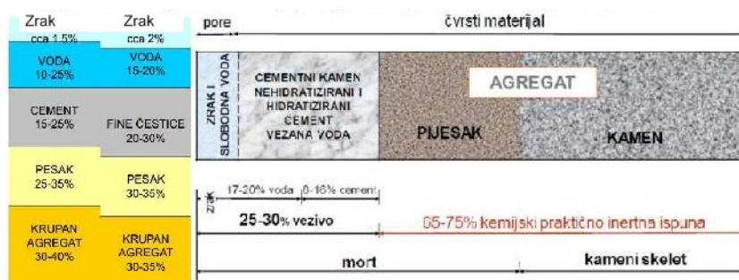
Slika 2.2. Omjer zastupljenosti sastojaka samozbijajućeg betona [9]
