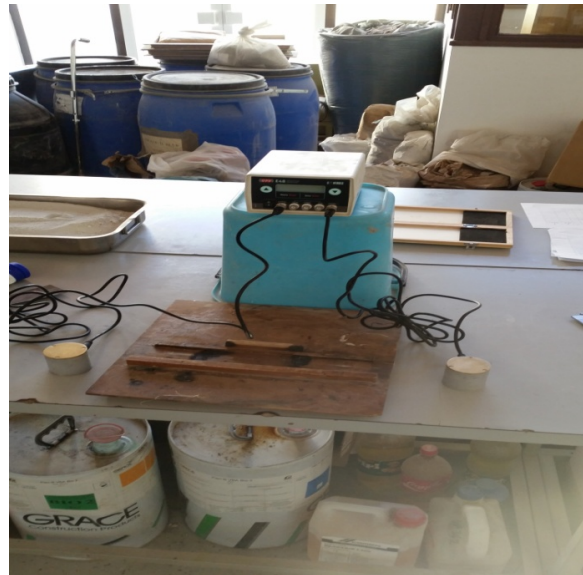
Slika 5.2 Uređaj za mjerenje ultrazvučnih valova [5]
