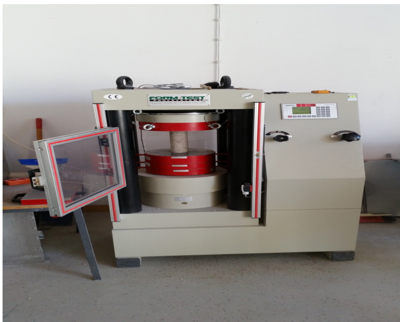
Slika 5.3 Ispitivanje tlačne čvrstoće [10]
