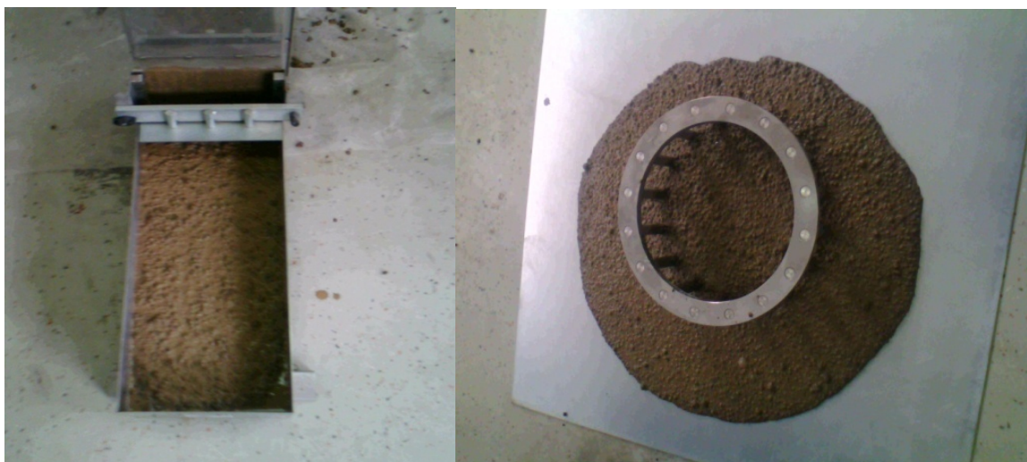
Slika 5.1. Ispitivanje obradivosti u L-box i J-ring [10, 11]
