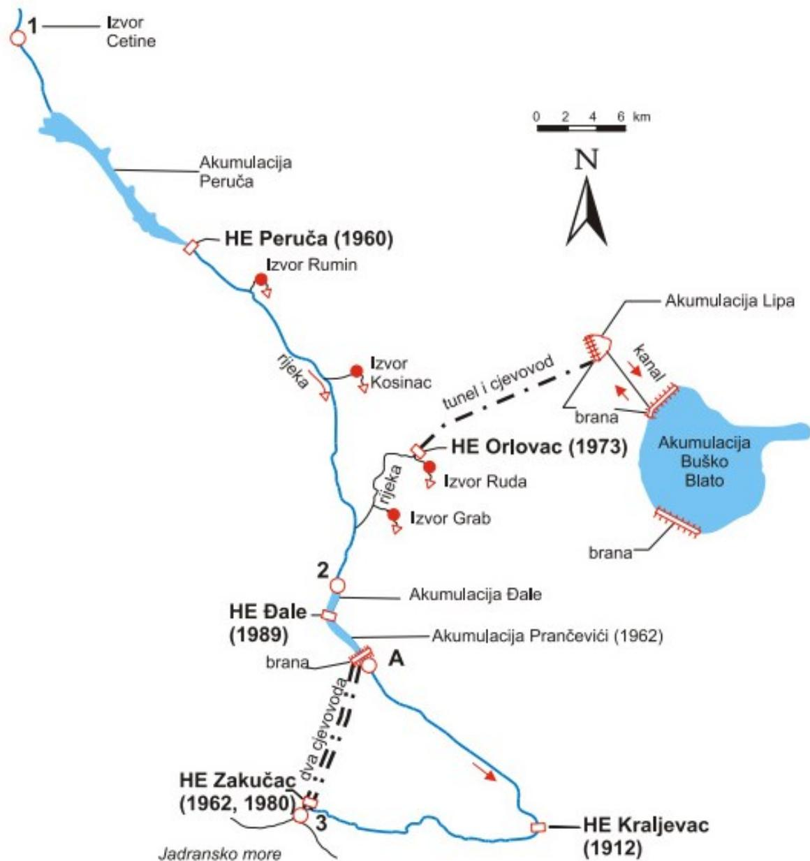
Slika 3. Shematski prikaz hidroenergetskog sustava na rijeci Cetini [13]
