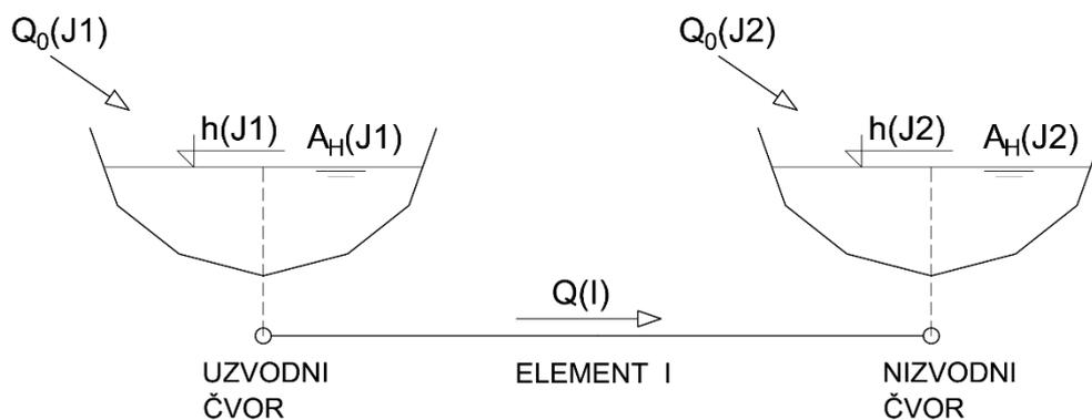
Slika 12 Uzvodni i nizvodni čvor elementa I
