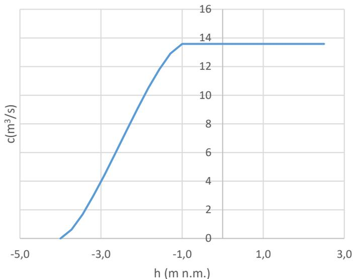
Slika 18. Odnos vodostaja i provodljivosti za cijev
